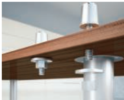
Montage der Befestigungsfüße Die Befestigungsfüße werden in die Montagebohrung eingesetzt und festgeschraubt. Hinweis: Einsetzbar in Tischplatten bis maximal 50 mm Stärke.
