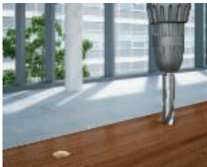
Vorbereitung für Befestigungsfuß-Montage Für die Montage der Befestigungsfüße sind Bohrungen (Ø 16 mm) in der Tischplatte erforderlich.
