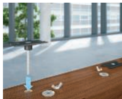
Vormontage des Befestigungs-Sets, Tischmontage Die Befestigungselemente werden in die Montagebohrung eingesetzt. Hinweis: Die beigelegten Befestigungsschrauben (M4 x 40mm) sind für Tischplatten bis maximal 32 mm Stärke verwendbar.
