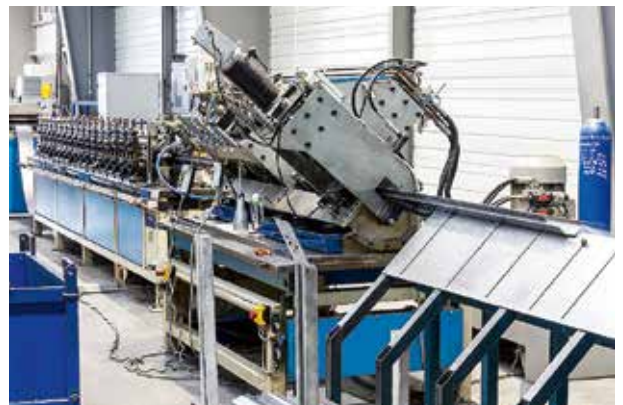
Profilierungsstrecke für Rahmenstützen
