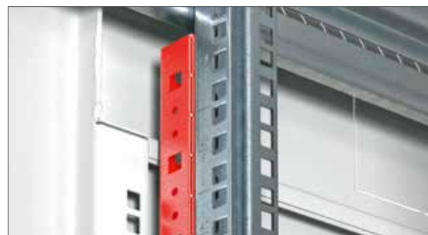
RAX-VR-Txx-X2 Ein zusätzliches Profil erhöht die Stabilität der vertikalen Montageleisten (4 St.). Es steigert die Tragkraft des Verteilers auf 1500 kg. Verwendbare
