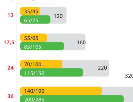
Luftabstand gemäß IEC 71-2 Phase / Phase (mm), Phase / Erdung (mm),
