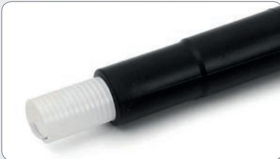
Raytech hat in seinen Laboratorien und in seinen Fertigungslinien eine Spiralhalterung mit ausgeklügeltem Profil entwickelt, auf der die Verbindung lagert. Die Halterung, die auf den Spritzmaschinen von Raytech gezogen und auf den Anwendungsdurchmesser an den entsprechenden und automatisierten Verpackungslinien geformt wird, wird in den Verbindungskörper gesteckt.
