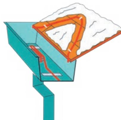
In der Zeichnung werden die Trassenführung der Dachtraufen, der Eingang des Kabels in die Regenrinne und die Trassenführung der Dachfläche dargestellt.
