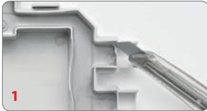
**1** Einschneiden der Membrane in Boden und Deckel.
