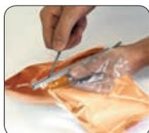
Abscheider aus dem Beutel Rayresin entfernen.
