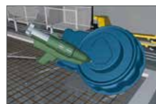
Coller la boîte grande taille Flex XXL avec de la colle thermofusible sur la table de coffrage.
