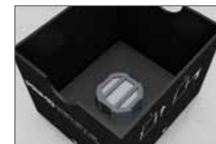
Option 2 : Le set de coffrage est fixé sur la table de coffrage par aimant.
