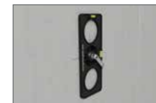
Le gabarit de perçage est fixé en fermant le levier.
