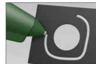
Option 1 : Le set de coffrage est collé sur la table de coffrage avec de la colle thermofusible.
