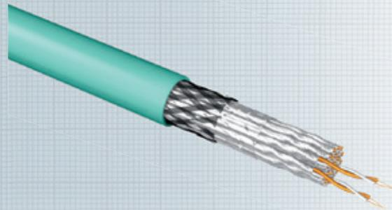
H.D.S. Innenkabel Kat. 7 S/FTP zur einfachen Schrank-zu-Schrank-Verkabelung in Rechenzentren und Multi-Verbindungen von Verteilerräumen zu Unterverteilungen. Der Kabelaufbau besteht aus 24 paargeschirmten Kabelelementen, je 4 Paare sind zu einem Verseilelement zusammengefasst.
