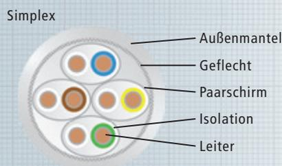
Datenkabel zur Übertragung analoger und digitaler Signale bei Verkabelung im Primär-, Sekundär- und Tertiärbereich. Geeignet für Anwendungen bis Klasse FA.
