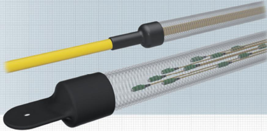
Direkt auf die Adern konfektionierte Stecker mit folgenden Vorteilen: Komfortabel in der Weiterverarbeitung, kompakt im Aufbau und günstig im Preis. Die vorkonfektionierten Adern können sicher und schnell mit den Kupplungen verbunden werden. Das Spleißen oder Konfektionieren vor Ort ist nicht mehr nötig. Die Produktion erfolgt, wie bei allen unseren LWL-Trunks, unter Laborbedingungen auf dem höchsten Stand der Technik.
