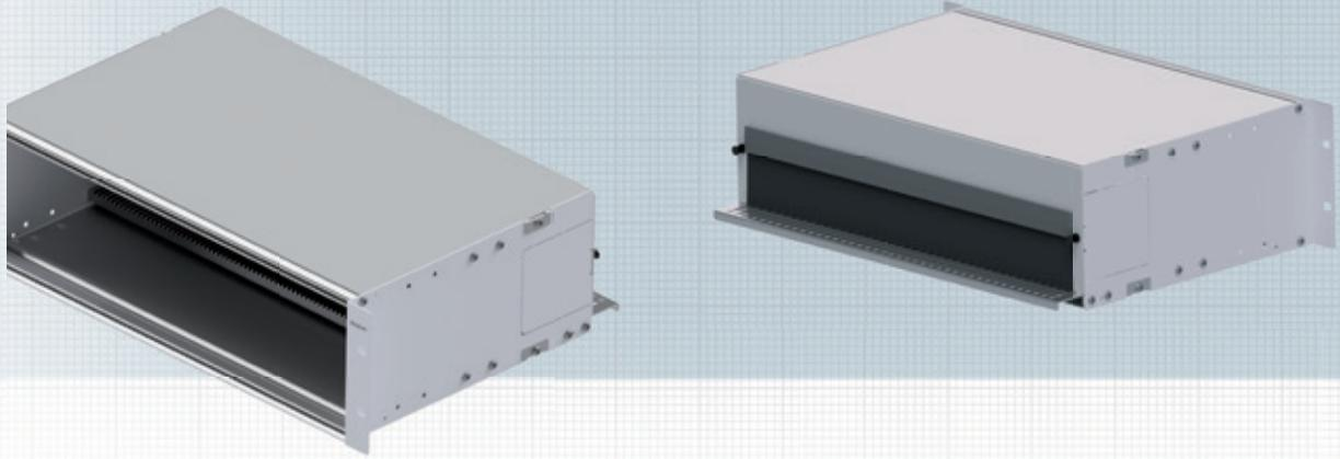
Modulträger 19" 3HE für den Einsatz von 7TE-Einschubmodulen in Kupfer und Glasfaser. Sie werden über 2 Schrauben von der Panelseite am Modulträger fixiert. Die Einschubmodule lassen sich komplett aus dem Modulträger herausziehen. Es können maximal 12x 7TE-Einschubmodule im Modulträger befestigt werden.
