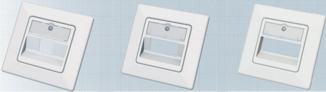
Die Modulaufnahmen SL sind besonders für den Einbau im Kabelkanal (EK), die Unterputzmontage (UP) und zur Aufputzmontage (AP) geeignet. Durch das Wegbrechen von zwei Montagelaschen ist auch eine Bodentankmontage (BT) möglich. Die Modulaufnahme SL kann ein bis drei EasyLan-Keystones absolut sicher und dauerhaft aufnehmen. Sie besitzt ein großes, zentral befindliches Beschriftungsfenster für eine einfache Kennzeichnung.
