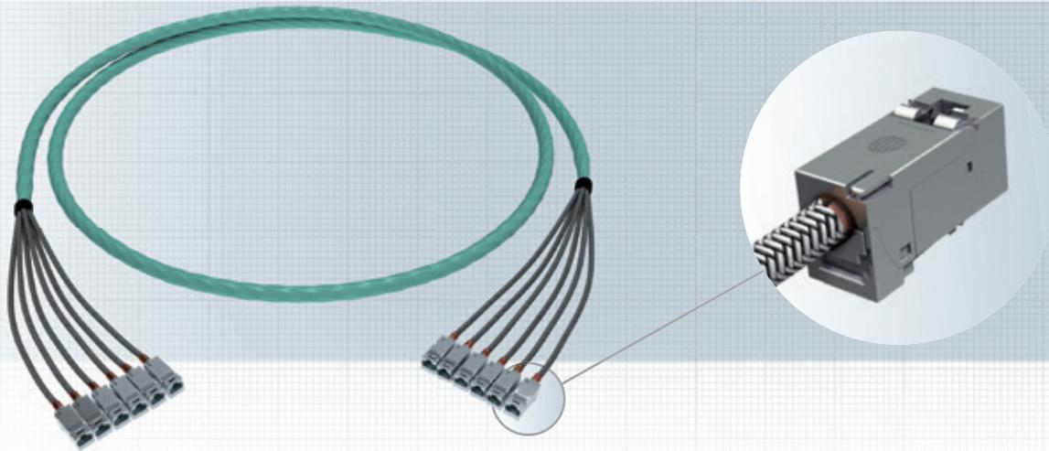
Das CTCC-Aufteilsystem bietet sich aufgrund seines minimalen Kabeldurchmessers und der dementsprechend geringen Brandlast für den flexiblen Einsatz in der strukturierten Gebäudeverkabelung und in Rechenzentren an. Die maximale Länge des Mehrfachkabels beträgt je nach Typ 60-90 m. Das Aufteilsystem als 10-Gbit-Lösung für RZ-Verkabelungen erfüllt mindestens die Anforderung der Klasse E<sub>A</sub>.
