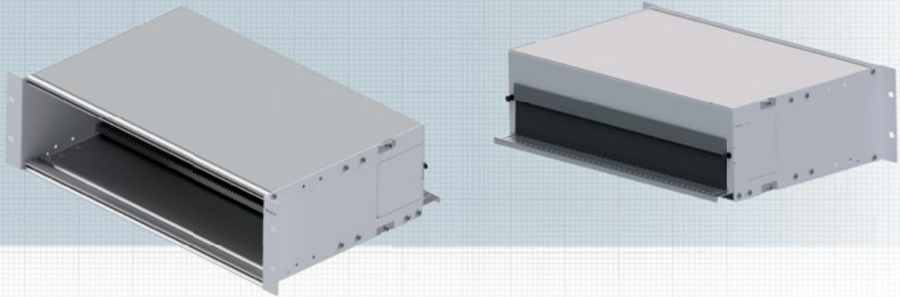
Modulträger 19" 3HE für den Einsatz von 7TE-Einschubmodulen in Kupfer und Glasfaser. Sie werden über 2 Schrauben von der Panelseite am Modulträger fixiert. Die Einschubmodule lassen sich komplett aus dem Modulträger herausziehen. Es können maximal 12x 7TE-Einschubmodule im Modulträger befestigt werden.
