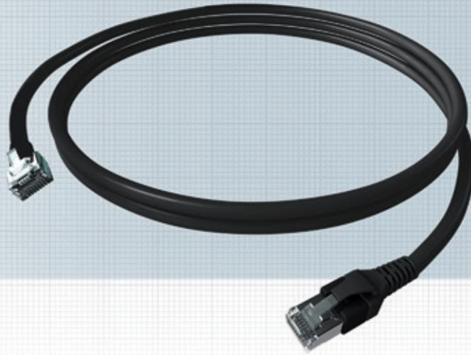
Verbindungskabel RJ45/RJ45, geschirmt mit einer 1:1 Belegung. Einseitig wird hier ein saCon Stecker mit DualBoot Umspritzung verwendet. Auf der zweiten Seite wird ein sehr kompakter RJ45 Stecker verwendet. Dieses Kabel wurde speziell für die VoIP-Anwendung entwickelt, da in VoIP-Telefonen oft sehr wenig Platz für den Stecker vorhanden ist. Das verwendete Kabel bietet durch seinen Geflechtschirm mit Paarschirmung sowie den 360° geschirmten RJ45-Steckern ein Höchstmaß an Datensicherheit.
