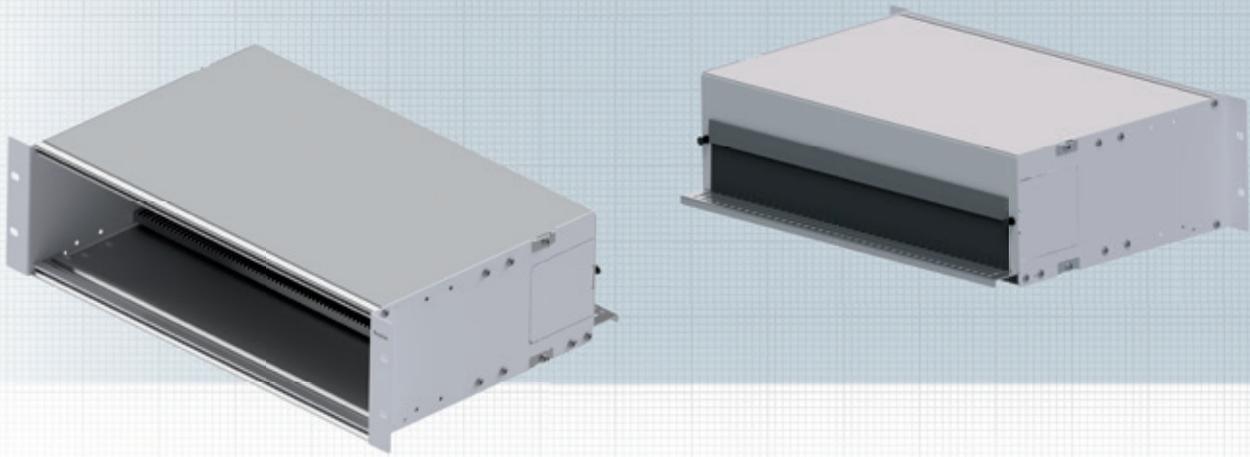
Modulträger 19" 3HE für den Einsatz von 7TE-Einschubmodulen in Kupfer und Glasfaser. Sie werden über 2 Schrauben von der Panelseite am Modulträger fixiert. Die Einschubmodule lassen sich komplett aus dem Modulträger herausziehen. Es können maximal 12x 7TE-Einschubmodule im Modulträger befestigt werden.
