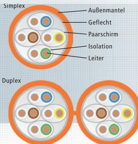
Datenkabel zur Übertragung analoger und digitaler Signale bei Verkabelung im Primär-, Sekundär- und Tertiärbereich. Geeignet für Anwendungen bis Klasse F.
