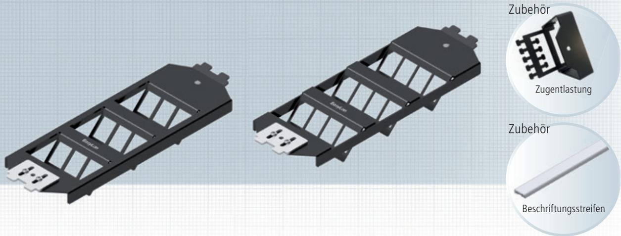
Der Keystone-Bodentankträger ersetzt den Geräteträger und bietet somit ein größtmögliches Platzangebot in der Kabelführung. Die schräge Zu- und Abführung ermöglicht eine sichere Kabelführung auch bei sehr niedrigen Zwischenböden. Die Einbauplatten werden mit zwei Schrauben an der Trägerplatte befestigt, nicht benötigte Keystone-Ausbrüche des Bodentankträgers können mit Blindplatten staubsicher abgedeckt werden. Die Bodentankträger sind kompatibel mit dem PUK-Bodentanksystem.
