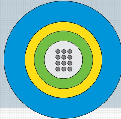
Das universelle LWL-Kabel ist mit einer zentralen Bündelader schlank und kostengünstig aufgebaut. Es ist metallfrei, längswasserdicht, zugfest, nagetiergeschützt und UV-beständig und kann als Hauseinführungskabel im Außenbereich in geeigneten Rohren und Schächten eingesetzt werden. Es ist halogenfrei-flammwidrig und kann im Innenbereich auf Trassen und als Steigekabel verlegt werden.
