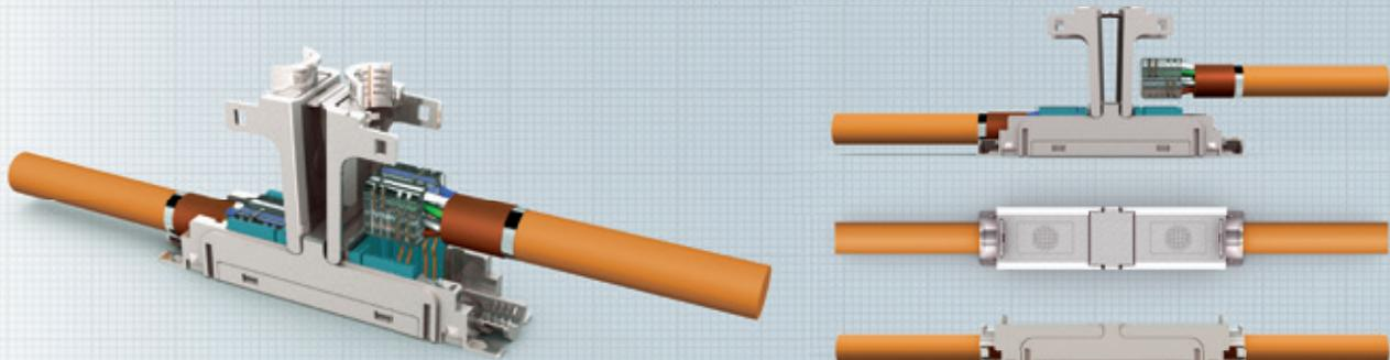
Mit dem preLink® Extender können Leitungen ohne viel Aufwand verlängert, Brandabschnitte überbrückt oder Teilnehmeranschlüsse ohne Zwischenpatchung direkt mit dem Consolidation Point verbunden werden. Des Weiteren können stillgelegte Leitungen reaktiviert und bis zum nächsten benötigten Anschluss verlängert werden. Der knappe Raum im Kabelkanal wird damit optimal genutzt.
