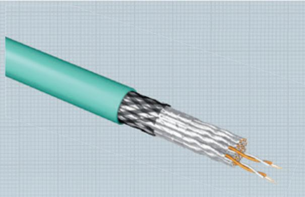
H.D.S. Innenkabel Kat. 7 S/FTP zur einfachen Schrank-zu-Schrank-Verkabelung in Rechenzentren und Multi-Verbindungen von Verteilerräumen zu Unterverteilungen. Der Kabelaufbau besteht aus 24 paargeschirmten Kabelelementen, je 4 Paare sind zu einem Verseilelement zusammengefasst.
