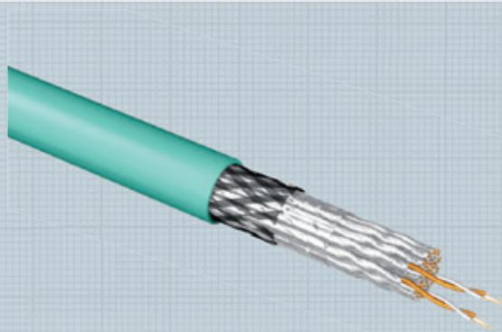
H.D.S. Innenkabel Kat. 7 S/FTP zur einfachen Schrank-zu-Schrank-Verkabelung in Rechenzentren und Multi-Verbindungen von Verteilerräumen zu Unterverteilungen. Der Kabelaufbau besteht aus 24 paargeschirmten Kabelelementen, je 4 Paare sind zu einem Verseilelement zusammengefasst.
