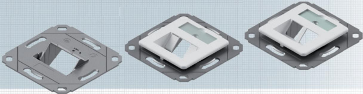
Die designfähige Modulaufnahme besteht aus einem Zinkdruckguss-Rahmen. Sie eignet sich für den Einbau in einem Kabelkanal (EK), für Unterputzmontage (UP) oder mittels separatem Rahmen auch zur Aufputzmontage (AP). Durch das Wegbrechen von zwei Montagelaschen ist auch eine Bodentankmontage (BT) möglich. Die designfähige Daten-dose ist mit nahezu allen am Markt erhältlichen Schalterprogrammen kombinierbar.
