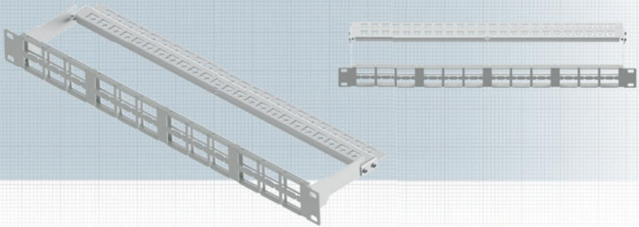
Das Verteilerfeld 19" 1HE ist beschaltbar mit bis zu 48 fixLink® Pro / Pro+ RJ45 Keystone-Modulen. Es ist in zwei Ebenen aufgebaut, somit sind die Module bündig in der Frontplatte.
