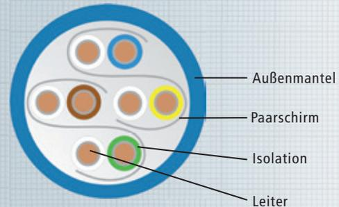
Datenkabel zur Übertragung analoger und digitaler Signale bei Verkabelung im Primär-, Sekundär- und Tertiärbereich. Geeignet für Anwendungen bis Klasse E<sub>A</sub>.
