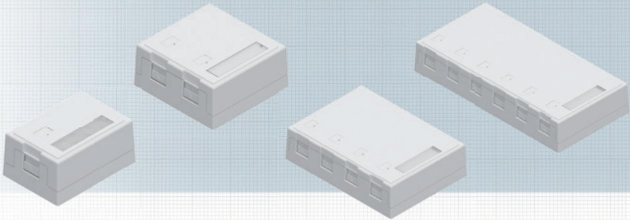
Das Aufputz Gehäuse ist für die Aufnahme von preLink®/fixLink® RJ45 Keystone-Module (nicht geeignet für fixLink® Pro/fixLink® Pro+ Keystone Module). Zum Lieferumfang gehören ein Beschriftungsfeld, eine entsprechende Anzahl von Markierungsclips und Kabelbindern, sowie Wandmontageschrauben und ein doppelseitiges Klebeband.
