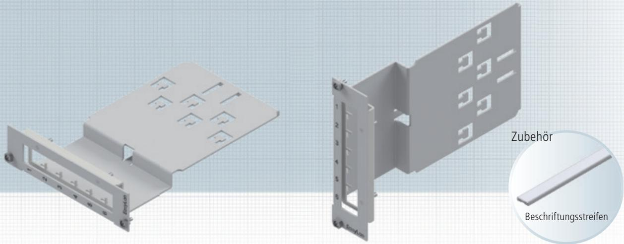
Keystone-Einschubmodul zur Bestückung von Modulträgern. Das Keystone-Einschubmodul kann mit bis zu 6 preLink®- bzw. fixLink®-Keystone-Modulen bestückt werden. Das Keystone-Einschubmodul ist in zwei Ebenen aufgebaut, somit sind die Module bündig zur Frontplatte. Die Kabelabfangung erfolgt direkt am Einschubmodul-Gehäuse. Es können 6 Einzelkabel oder 1 Trunkkabel befestigt werden.
