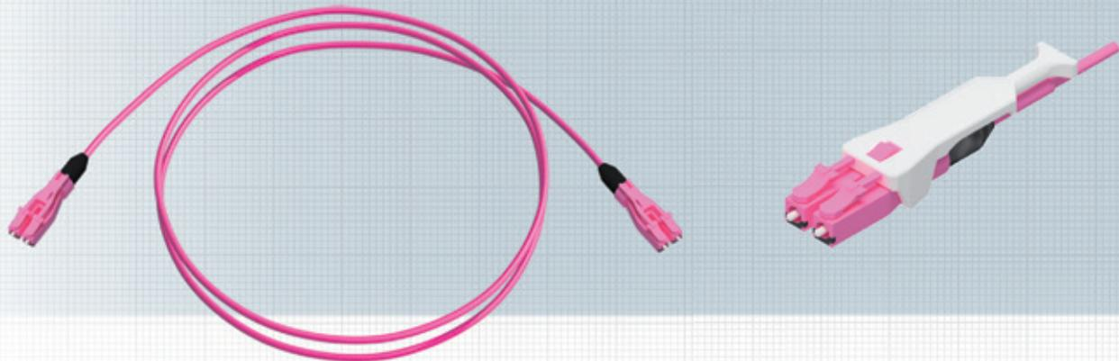
Das LC-Uniboot-Duplex Patch- und Adapterkabel ist durch die Verwendung von extrem schlanken Duplex Rundkabeln (Außendurchmesser 2,1 mm) besonders in Rechenzentren für High Density Anwendungen geeignet. Der LC Duplex Uniboot Stecker ist ein Steckverbinder für 2 Fasern mit einer Markierung für den aktuellen Polaritätsstatus. Die Änderung der Polarität ist dabei jederzeit möglich. Durch einen optionalen PushPull Tab kann der Stecker auch bei einem vollen Patchfeld problemlos demontiert werden.
