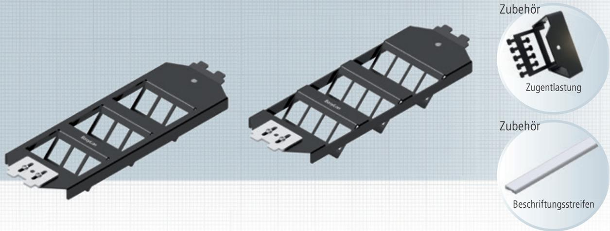
Die Bodentankträger sind kompatibel zum PUK Bodentanksystem und ersetzen den PUK Universalträger. Sie bieten ein größtmögliches Platzangebot in der Kabelzuführung. Die flache Zu- und Abführung der Kabel ermöglichen eine geringe Einbauhöhe auch bei sehr niedrigen Zwischenböden. Ebenso weisen sie eine volle Kompatibilität zu E-DAT<sup>®</sup>\* (Modulausschnitt: Modul) auf. Eine Erdung erfolgt mittels M4 Ringkabelschuh.
