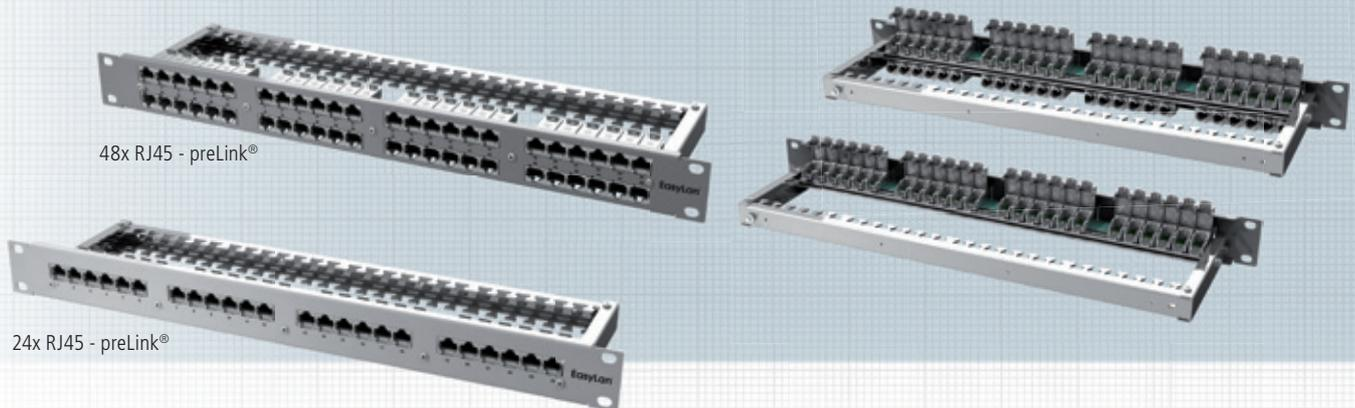
Beim preLink® RZ-Patchpanel sind die RZ-Module bereits auf einer Schiene vormontiert und müssen nur noch mit dem jeweiligen Kabelabschlussblock komplettiert werden. Hier empfehlen sich speziell die vorkonfektionierten RZ-Lösungen, die entweder als Einzel- oder als Mehrfachkabel bestellt werden können. Die Buchsenmodule aus Zinkdruckguss sind durch ihre schmale Bauform besonders bei hohen Packungsdichten in den RZ-Paneln mit bis zu 48 Ports auf 1HE geeignet.
