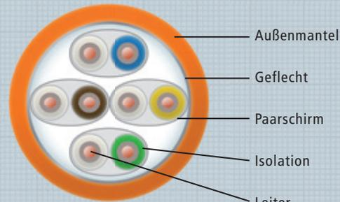
Datenkabel zur Übertragung analoger und digitaler Signale bei Verkabelung im Primär-, Sekundär- und Tertiärbereich. Geeignet für Anwendungen bis Klasse FA.
