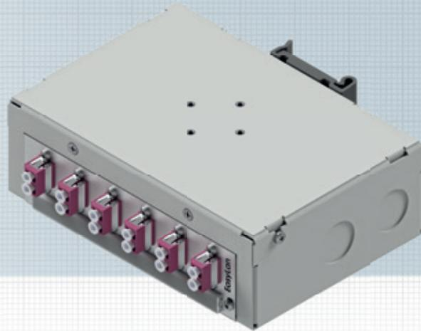
Das Hutschienenmodul M20 ist für Teilfrontplatten 3HE / 7TE und für bis zu 24 Spleiße konzipiert. Das Hutschienenmodul kann einfach und flexibel auf DIN Schienen eingeklickt oder direkt an der Wand befestigt werden. Mit jeweils 2x M20 Eingängen auf den gegenüberliegenden Seiten eignet sich somit als Endverteiler für Anwendungen im Hohlboden oder für Wandmontagen.
