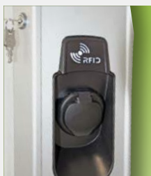
Ladesteckdose Typ 2 mit RFID-Reader
