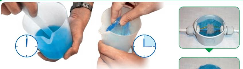
Die Komponenten in den Messbecher gießen, mischen und vernetzen lassen (etwa 15 Minuten). Die Isolierung entfernen und in kleinen Stücken um den Anschluss herum positionieren, so dass dieser vollständig bedeckt wird. Natürlich kann die von früheren Mischungen aufbewahrte Isolierung verwendet werden.
