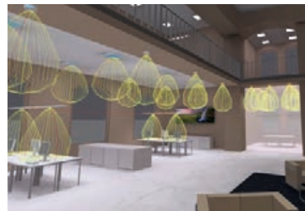
3D-Ansicht einer ausgewogenen Positionierung von Sensoren und Lichtquellen zur Erreichung der gewünschten Lichtverteilung.
