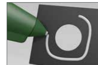
Option 1: Schalfix wird mit Heißkleber auf Schaltisch geklebt.
