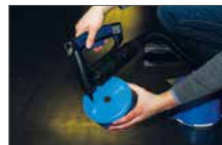
1. Variante: Mit Heißkleber auf Schaltisch kleben.
