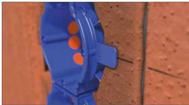
Durch die seitlichen Laschen ist die Putzstärke von 1 cm vorgegeben.
