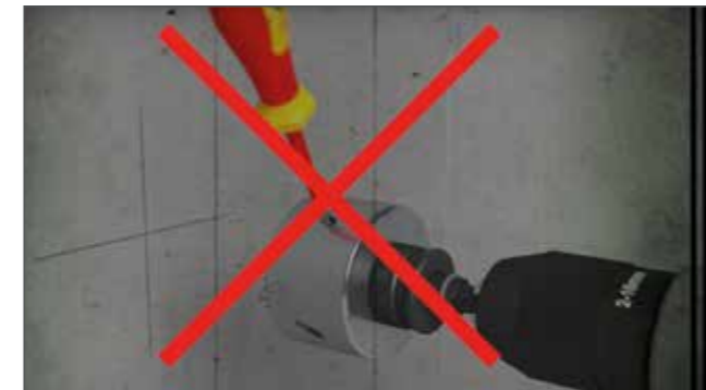
Herkömmliches und Zeitaufwändiges entfernen des Bohrkerns.
