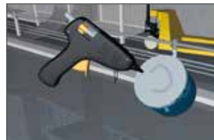
XL 170 Einbaugehäuse mit Heißkleber auf den Schaltisch kleben.
