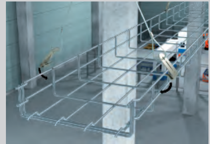
Einfache und schnelle Montage durch Einhängen der oberen Längsdrähte der Gitterrinne in die am Y-Abhänger vormontierten Universalhalter.
