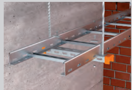
Montage auf Querprofil mit Klemmstück, Flachrundschaublen und großen Unterlegscheiben.
