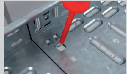
Schraubenlose Stoßstellenverbindung, nur Umbiegen der Bodenlaschen erforderlich.
