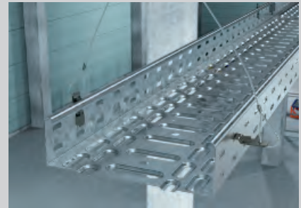
Einfache und schnelle Montage der am Y-Abhängers vormontierten Universalhalter durch Einstecken in die Seitenholmlochung.
