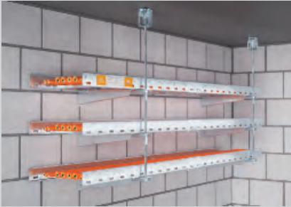
Wandmontage mehrlagig mit Gewindestangensicherung senkrecht.
