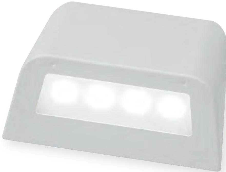
Optisch identisch, unterscheiden sich die beiden Leuchten bei den „inneren Werten“. Während der PM5 für den Außenbereich entwickelt wurde (IP65), haben wir den LM5 mit einer geringeren Schutzart (IP41) konstruiert. Um einer direkten Blendung entgegen zu wirken, besitzt der LED-Master LM5/PM5 eine satinierte Scheibe, welche einen Abstrahlwinkel von 45° aufweist. Konzipiert zur Ausleuchtung von Flächen im Innen- und Außenbereich gemäß DIN EN 1838.
