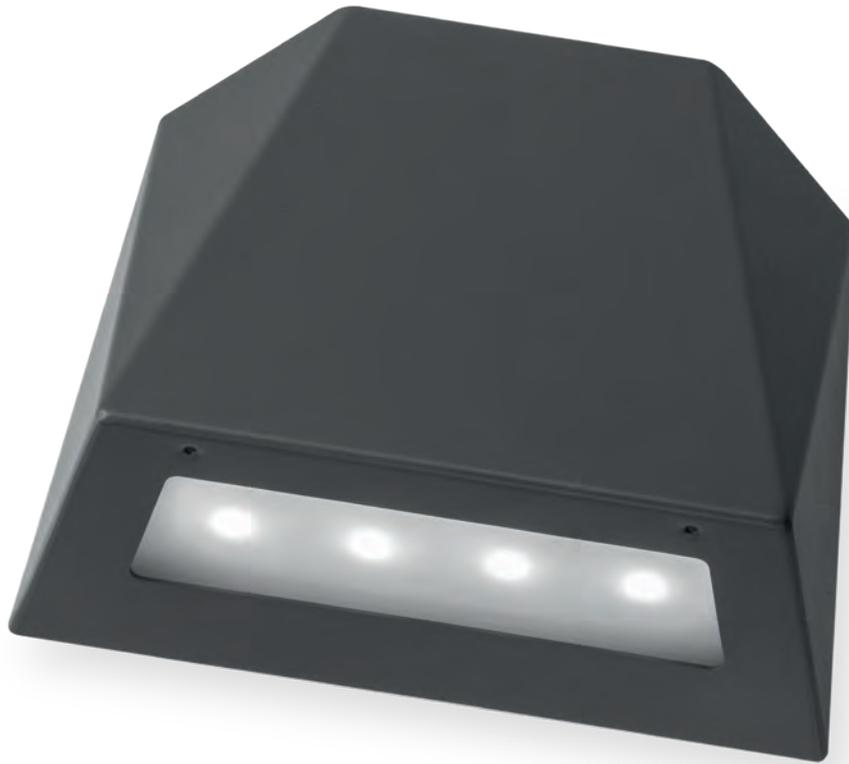
Ob als PM4 für den Außenbereich (IP65) oder als LM4 für den Innenbereich (IP41), beide Varianten sind optisch identisch. Um einer direkten Blendung entgegenzuwirken, besitzt der LED-Master LM4/PM4 eine satinierte Scheibe, welche einen Abstrahlwinkel von 45° aufweist. Konzipiert zur Ausleuchtung von Flächen im Innen- und Außenbereich gemäß DIN EN 1838.
