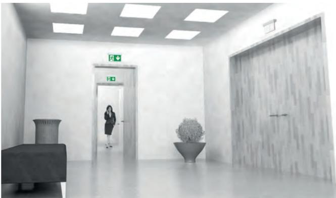
Während des Normalbetriebs kennzeichnet die Pfadfinder-Leuchte den 1. Fluchtweg. Die Kennzeichnung des alternativen 2. Fluchtweges ist blind.
