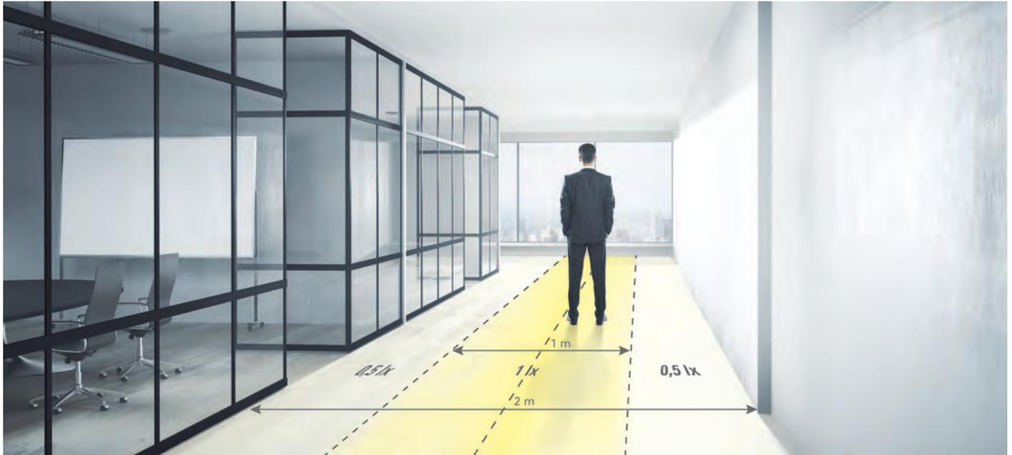
Bei Rettungswegen mit einer Breite von bis zu 2 m muss die Beleuchtungsstärke auf dem Boden entlang der Mittellinie mind. 1 Lux betragen. Der Mittelbereich, der nicht weniger als der Hälfte der Breite entspricht, muss mind. 0,5 Lux betragen.
