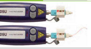
**Der Leviton Visual Fault Locator (VFL)** benutzt einen leuchtend roten Laser, um etwaige Fehler in der Glasfaser aufzuspüren, wie zum Beispiel Biegungen, Risse, Brüche und defekte Stecker. Der VFL ist mit einer2,5-Millimeter-Schnittstelle für ST- und SC-Stecker und mit einem 1,25-Millimeter-Adapter für LC-Stecker ausgestattet. Im Lieferumfang eingeschlossen ist zudem ein weicher Transportkoffer. Zur Verwendung mit LC-, SC- und ST FastCAM-Steckern.
