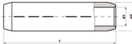
Anwendung: Für Al-Mittelspannungskabel 10-30 kV
