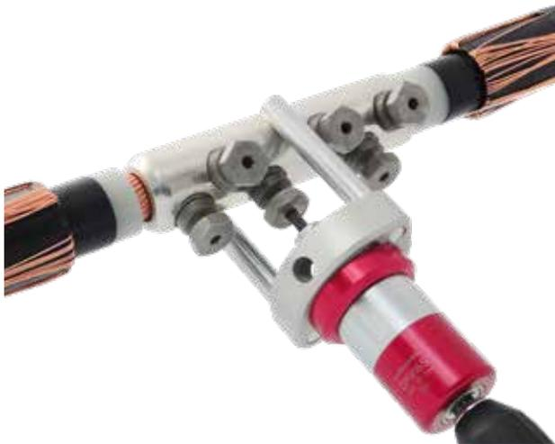
Zum kontrollierten Anziehen von Abreißschrauben an Schraubverbindern, verwendbar mit allen handelsüblichen Akkuschrauben mit einer Bohrfutteraufnahme min. Ø 10 mm.
