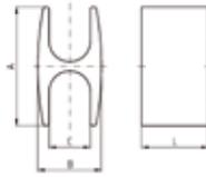
Anwendung: Für Cu-Seile nach DIN 48201
