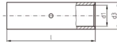
Anwendung: Für mehrdrähtige, feindrähtige, verdichtete mehr- und feindrähtige Leiter sowie für Massivleiter von 6 - 16 mm<sup>2</sup>
