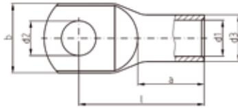
Anwendung: Für mehrdrähtige, feindrähtige, verdichtete mehr- und feindrähtige Leiter sowie für Massivleiter von 0,75 - 16 mm<sup>2</sup>
