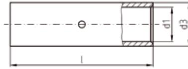
Anwendung: Für mehrdrähtige, feindrähtige, verdichtete mehr- und feindrähtige Leiter sowie für Massivleiter von 0,75 - 16 mm<sup>2</sup>
