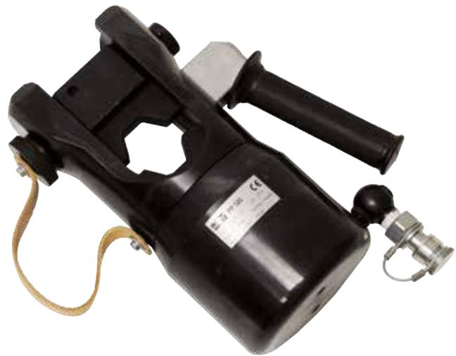
Der Presskopf kann mit einer Hydraulikpumpe (Maximaldruck 700bar/ 70MPa) betrieben werden. (siehe Seite 206-209, Hydraulische Antriebsaggregate)
