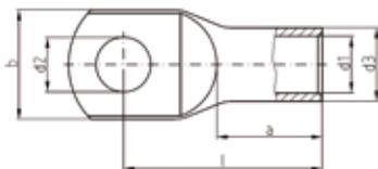
Anwendung: Für mehrdrähtige, feindrähtige, verdichtete mehr- und feindrähtige Leiter sowie für Massivleiter von 6 - 16 mm<sup>2</sup>
