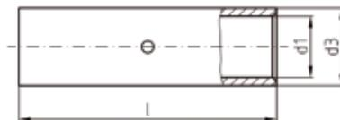
Anwendung: Für mehrdrähtige, feindrähtige, verdichtete mehr- und feindrähtige Leiter sowie für Massivleiter von 0,75 - 16 mm<sup>2</sup>
