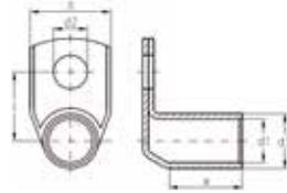
Anwendung: Für mehrdrähtige, feindrähtige, verdichtete mehr- und feindrähtige Leiter sowie für Massivleiter von 6 - 16 mm<sup>2</sup>
