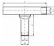
Anwendung: Für mehrdrätige, feindrätige, verdichtete mehr- und feindrätige Leiter sowie für Massivleiter von 1 - 16 mm<sup>2</sup>
