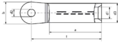
Anwendung: Für Al-Leiter nach DIN EN 60228 und Al-Seile nach DIN EN 50182
