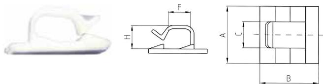
Zur Befestigung von Kabeln, Schläuchen, Rohren etc.
