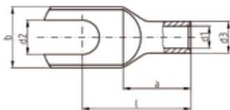
Anwendung: Für mehrdrähtige, feindrähtige, verdichtete mehr- und feindrähtige Leiter sowie für Massivleiter von 0,75 - 4 mm<sup>2</sup>
