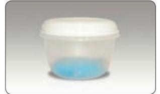
das übrig gebliebene bereits vernetzte Gel kann leicht aus dem Messbecher entfernt und für eine spätere Verwendung aufbewahrt werden.
