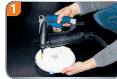
1. Variante: Deckel mit Heißkleber auf den Schaltisch kleben.
