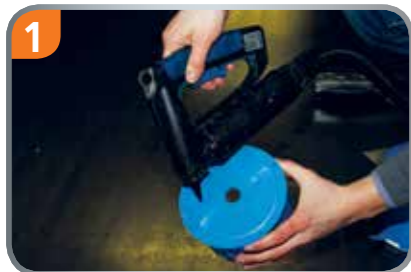
1. Variante: Mit Heißkleber auf Schaltisch kleben.
