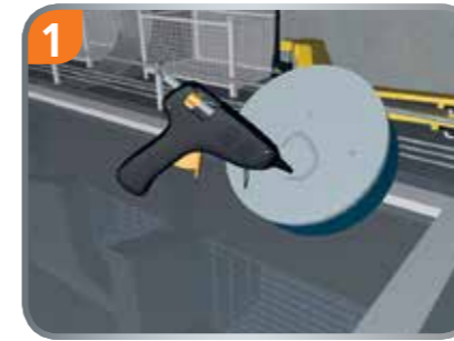
306 mm Ø Unterteil/Deckel mit Heißkleber auf den Schaltisch kleben.
