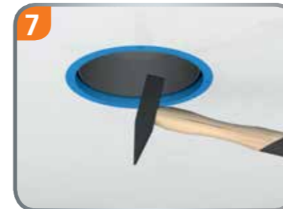
7. Lüftungshülse von unten mit Hammer einschlagen.
