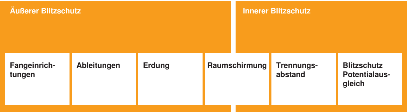
Systeme des äußeren und inneren Blitzschutzes
