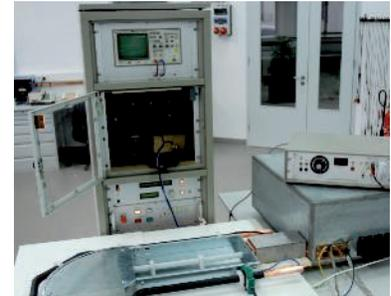
Die magnetische Schirmdämpfung von Kabeltrag-Systemen ist das Verhältnis in Dezibel (dB) einer induzierten Spannung in ein ungeschütztes Kabel zu der induzierten Spannung in das gleiche Kabel, wenn sich dieses in einem Kabeltrag-System befindet.
