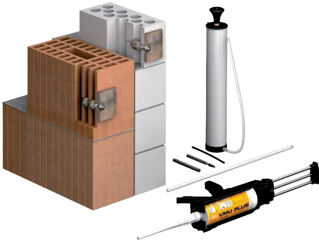
Das Injektionsmörtel-System VMU Plus ist besonders geeignet für die Befestigung in Hochlochziegeln, Beton, Kalksandstein, Kalksandlochstein und Mauerziegel. Die spreizdruckfreie Verbindung wird durch den Einsatz der Kunststoffsiebhülse und einer Gewinde-Ankerstange hergestellt. Geprüft und zugelassen sind die Komponenten für eine Feuerwiderstandsdauer von 90 Minuten.
