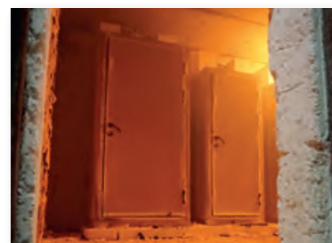
Brandkammer mit funktionsfähigen Einbauten nach 90 minütiger Beflammung.
