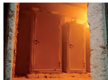
Brandkammer mit funktionsfähigen Einbauten nach 90 minütiger Beflammung.
