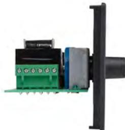
Le SVC6.2T relié à un amplificateur 100V, permet de créer 6 zones différentes de volume (100W maximum par canal). Les boutons en façade permettent de régler séparément ou d'éteindre complètement le volume de chaque zone. Chaque canal possède de son propre relai de rétablissement de niveau (24V DC). L'appareil est prévu pour s'intégrer dans un rack 19".
