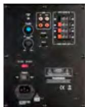
Les boutons rotatifs permettent d'adapter l'effet du subwoofer à la pièce dans laquelle il est installé. Si nécessaire, il peut aussi commander les petits satellites.
