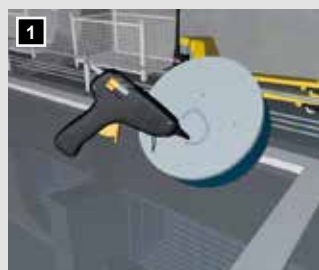
306 mm Ø Unterteil/Deckel mit Heiß- kleber auf den Schaltisch kleben.
