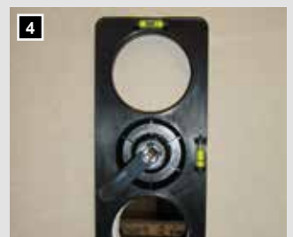
4 Befestigen der Bohrschablone mit dem Spanner.
