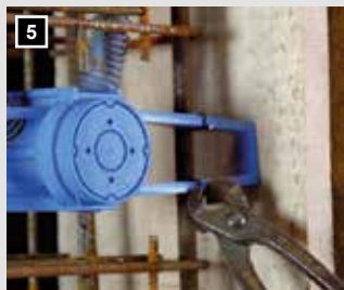
5 Einfach auf die Stahlarmierung binden. Betondeckung bis 40 mm.
