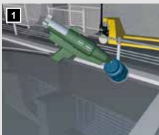
1 Universalgroßdose mit Heißkleber auf den Schaltisch kleben.
