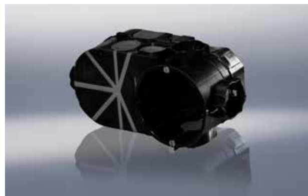
Die Elektronikdose in winddichter Ausführung ermöglicht z. B. einen komfortablen Einbau von elektronischen Bauteilen und bietet genügend Freiraum zur Einhaltung des Biegeradius bei der Verlegung von Datenleitungen.
