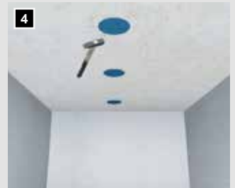
4 Öffnung mit dem Hammer ausschlagen.
