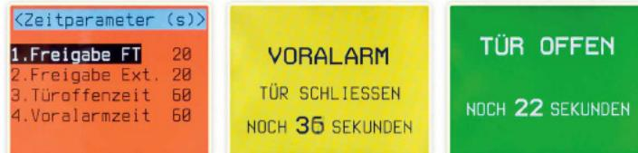
Dies ermöglicht zum einen die verständliche Anzeige für Betriebszustände und zum anderen eine einfache Einstellung der Parameter mittels Servicemenü. Auch was die Flexibilität betrifft, öffnet das System neue Wege, indem es den Produktmix verschiedener Hersteller oder auch die nachträgliche Vernetzung von Stand-Alone-Systemen ohne Austausch bestehender Geräte erlaubt.
