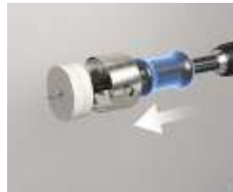
Bohrkern mittels Schiebegriff herausschieben und entnehmen.
