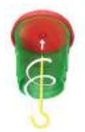
Metallmutter M5 – Sichere Aufnahme von Leuchtenhaken nach DIN EN 60670 bis 100 N (10 kg).
