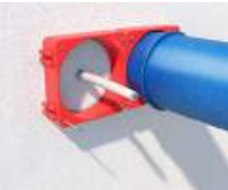
Mittels SPECIAL Fräser (Art.-Nr. 1088-07) und zwei Zentrierhilfen (Art.-Nr. 1090-68) zwei Einbauöffnungen von mind. 55 mm Tiefe im Durchmesser 68 mm erstellen.
