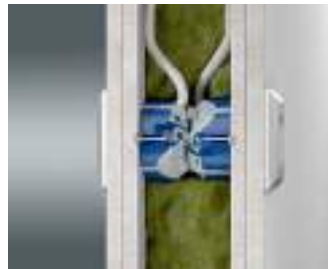
Auch für den direkt gegenüberliegenden Einbau bis zu einer 5-fach Kombination.
