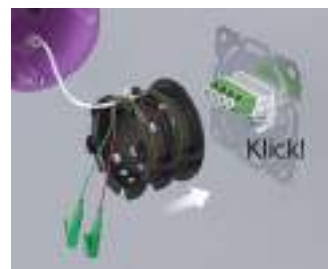
Fasermanagement Trommel mit dem Tragring verrasten.
