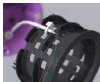
Glasfasern auf der Fasermanagement Trommel ablegen.
