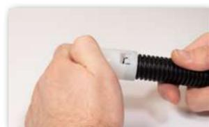
**2** Das Rohr kann bis zum Anschlag eingeführt werden, sodass sich die beiden Enden mittig treffen.
