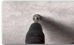
**2** Durch den Anschlag ist die optimale Tiefe des Bohrlochs definiert.
