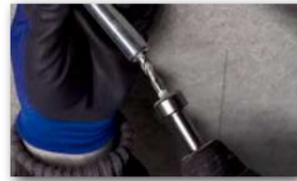
**3** Setzwerkzeug auf den Bohrer aufsetzen und Schlag einstellen.
