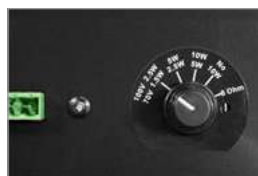
puissance réglable avec sélecteur
