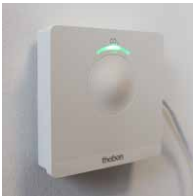
LED-Ampelsystem beim AMUN 716 CO 2 Monitor
