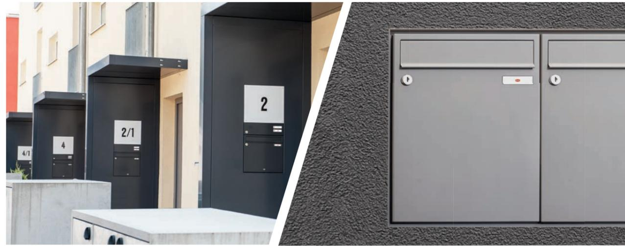
Für einen präzisen Einbau und ein elegantes Aussehen ist der Schattenfugenrahmen konzipiert. Damit kann die Briefkastenanlage mit einer umlaufenden, gleichmäßigen 8 mm breiten Schattenfuge putzbündig montiert werden. Gefertigt wird der Unterputzrahmen aus Aluminium, wahlweise farbig pulverbeschichtet oder eloxiert.
