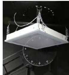
Gonio-Photometer Vermessung Leuchte
