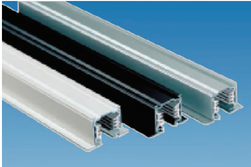
3-Phasen-Flügel-Einbaustromschiene (440V 16A CL1), Einbauöffnung 37mm
