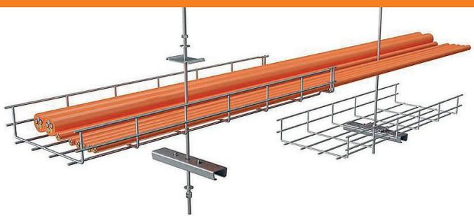
Nachdem die Mittenabhängung im Rinnenboden verschraubt wurde, wird durch Ineinanderstecken der Kabelrinnen eine Längsverbindung erstellt.
