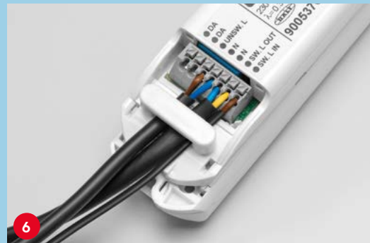
Schließen Sie die Netzleitung an den Notlicht-LED-Treiber an (Null-Leiter und ungeschaltete Phase) und fixieren Sie diese mit der Zugentlastung.
