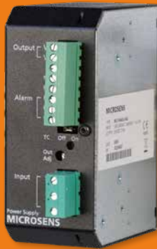
Bahnzertifiziertes 60 W Netzteil
