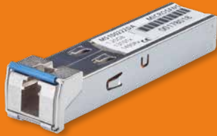
WDM SFP-Transceiver simplex mit erweitertem Temperaturbereich
