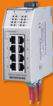
Gigabit Ethernet Switch für Bahn-/EVU-Anwendungen
