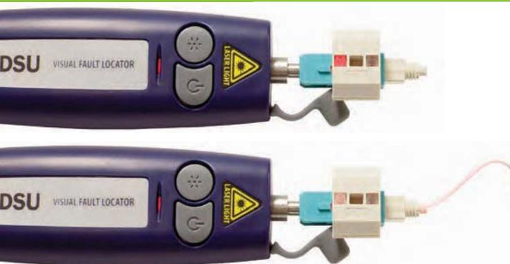
Der Leviton Visual Fault Locator (VFL) benutzt einen leuchtend roten Laser, um etwaige Fehler in der Glasfaser aufzuspüren, wie zum Beispiel Biegungen, Risse, Brüche und defekte Stecker. Der VFL ist mit einer 2,5-Millimeter-Schnittstelle für ST- und SC-Stecker und mit einem 1,25-Millimeter-Adapter für LC-Stecker ausgestattet. Im Lieferumfang eingeschlossen ist zudem ein weicher Transportkoffer. Zur Verwendung mit LC-, SC- und ST FastCAM-Steckern.
