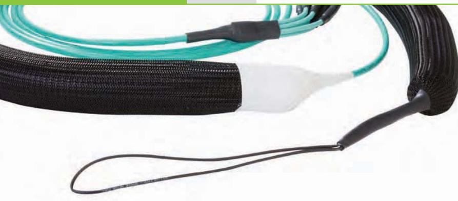
Die Zugöse schützt Faserverbindungen von 12- bis 144-Fasern Kabeltrunksn. Sie bedeckt die komplette Breakout Länge und tranferiert jegliche Zugkraft vom Strand zur Öse. Kunden können wählen, an welchem Ende die Zugöse gewünscht ist.
