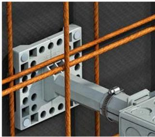
Wandstärke bis 20 cm: 8-Kant-Rohr an Sockel und Trägerplatte auf das passende Maß kürzen. Wandstärke 20 bis 25 cm: Teleskop-Abstützung auf das passende Maß einstellen.
