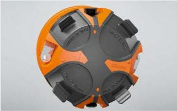
Luftdichte Geräte-Verbindungsdose mit ECON®-Technik speziell für die Installation mit Elektroinstallationsrohr. 4 Einführungen sind optimal für eine durchgängige Rohrinstallation z.B. im Fertighausbau oder bei Datennetzwerken. Besonders montagefreundlich dank werkzeugloser Rohreinführung per Öffnungslasche.
