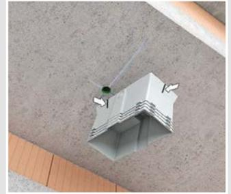
Ausrichtmarkierungen für die Leuchtenposition und den Befestigungspunkt.
