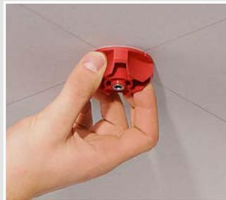
Mittelpunkt der Bohrung anzeichnen (ggf. Schneidzentrierer verwenden). Passende Drehzahl an der Bohrmaschine einstellen. Bleche vor dem Fräsen mit Ø 6 mm vorbohren.
