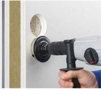
Zwei Einbauöffnungen mit Turbofräser MULTI 4000 Ø 74 mm (Art.-Nr. 1084-10) im Mittenabstand von 71 mm fräsen.
