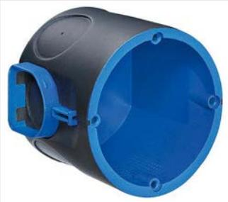
Die Schallschutzdose-Unterputz bietet 6 Einführungsmöglichkeiten für Rohre bis M25 und Leitungen bis  $\varnothing$  11,5 mm.
