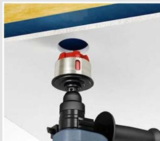
Zur Erweiterung bestehender Einbauöffnungen von Ø 68 mm auf Ø 74 mm Zentriereinsatz (Art.-Nr. 1083-99) verwenden.
