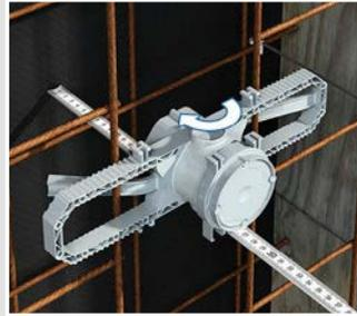
Die Frontseite der Geräte-Verbindungsdose muss zwischen 5 und 20 mm über die Wandstärke hinausragen, somit wird ein optimaler Druck auf die Gegenschalung erzeugt.
