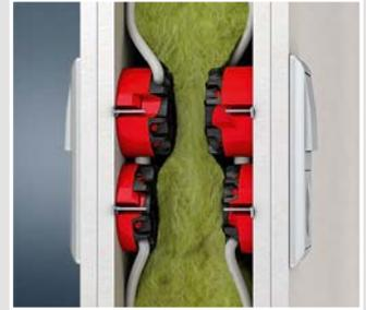
Gegenüberliegender Einbau von Gerätedosen in einer Wandstärke ab 100 mm und bei Geräte-Verbindungs-dosen in einer Wandstärke ab 125 mm möglich.
