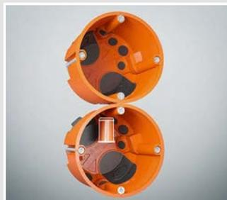
Für die luftdichte Kombination der Hohlwanddosen sorgt der Verbindungsstutzen, der werkzeuglos über die abziehbaren Laschen eingeföhrt wird.
