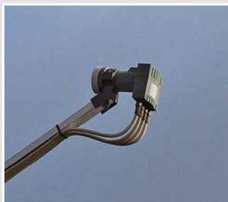
Hier werden 4 Koaxial-Leitungen für den Empfang angeschlossen.
