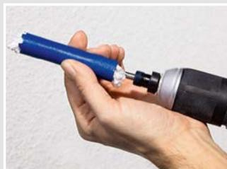
Durch einfaches Abschrauben der Fräskrone lässt sich der Bohrkern mittels Zentrierbohrer schnell entfernen.
