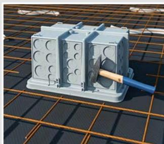
Die Befestigung auf der Deckenschalung erfolgt über 8 vormontierte Nägel. Die Nageldome verfügen über eine Sollbruchstelle, so dass die Nägel beim Entschalen mit entfernt werden.
