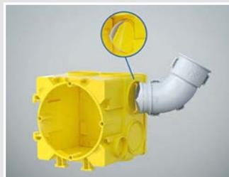
Spitze der Rohrkupplung 60° an der gewünschten Rohreinführung einstecken und drehen bis die Durchführung ausgeschnitten ist
