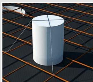
Mit Rödeldraht den Schalungskörper an der Bewehrung fixieren.
