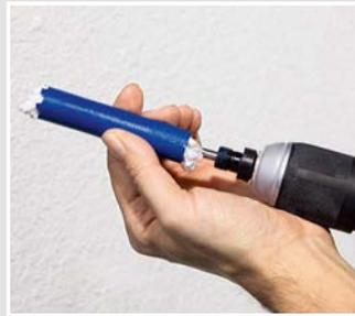
Fräskrone lösen und Bohrkern entfernen.
