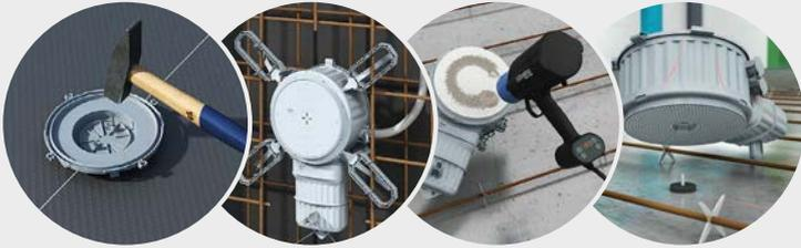
**Kombinationseinführung für Rohre M20/M25 – werkzeuglose Öffnungstechnik** mit sicherer Rohrrückhaltung und Tiefenanschlag, ohne dass ein innseitiges Kürzen der Rohre erforderlich ist. Wiederbelegbar bei Installationsänderungen oder Fehlbelegungen.
