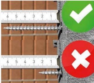
Die Dübel-Schraube muss das Grundelement um mind. 40 mm überragen.
