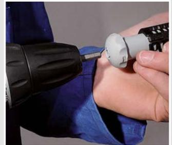
TIPP: Um mehrere Öffnungen zu schneiden oder harten Kunststoff zu bearbeiten, können Sie den Öffnungsschneider auf den 1/4"-Bit eines Akkuschraubers aufsetzen.
