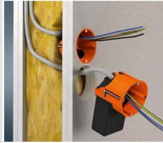
Leitung oder Rohr luftdicht durch die elastische Dichtungsmembran einführen.
