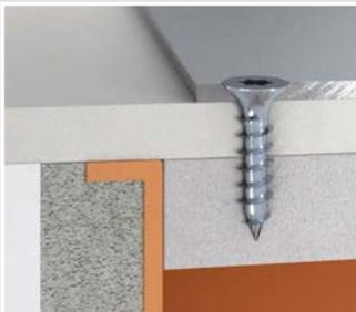
Bei der Gerätebefestigung verwenden Sie nur Schrauben, die in, aber nicht durch die Mineralfaserplatte reichen (z. B. SPAX Senkkopf 3,5 x 15 mm)!
