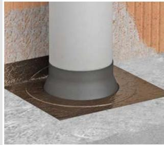
Vor dem Anpressen des Klebekragens den Primer bis zur Transparenz ablüften lassen. Eingedickter Primer kann mit Wasser verdünnt werden.
