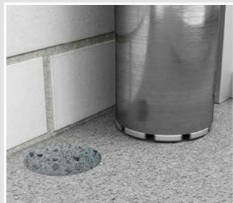
Erstellung einer Kernlochbohrung 150 mm oder 100 mm.
