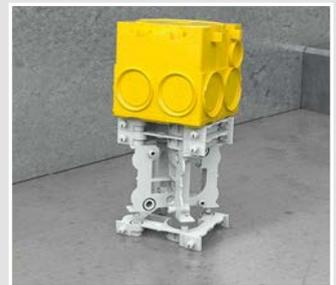
Das Gegenlager wird bei oberliegenden Dosen als Anfangselement auf dem Schaltisch benötigt. Es ist mit oder ohne Spezial-Haftkleber erhältlich und kann mit Aufstockelementen sowie Geräte-Verbindungsboxen kombiniert werden.
