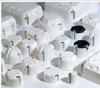
Bei den Hohlwanddosen und -kästen, welche mit einem VDE-Zeichen gekennzeichnet sind, wird die Feuerbeständigkeit durch eine Glühdrahtprüfung mit 850 °C getestet (gemäß VDE 0471 / DIN EN 60695-2-11). Dabei muss nachgewiesen werden, dass im Fall einer fehlerhaften Elektro-Installation kein Brand durch die Hohlwanddosen ausgelöst wird. Unabhängig davon sind die einschlägigen Brandschutzmaßnahmen der Wandkonstruktion einzuhalten.
