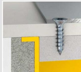
Bei der Gerätebefestigung verwenden Sie nur Schrauben, die in, aber nicht durch die Mineralfaserplatte reichen (z. B. SPAX Senkkopf 3,5 x 15 mm)!
