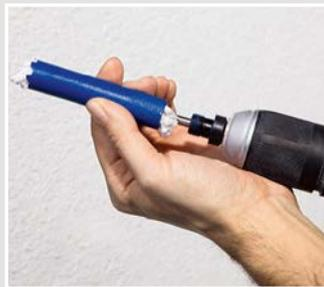
Durch einfaches Abschrauben der Fräskrone lässt sich der Bohrkern mittels Zentrierbohrer schnell entfernen.
