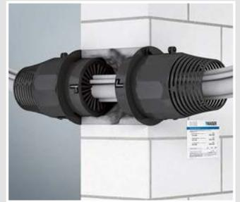
Dichtelement auf den Schottzylinder setzen und mit einer ¼-Drehung befestigen (Bajonetverschluss).
