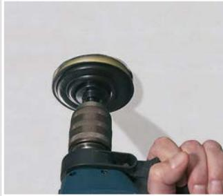
Einbauöffnung mit Turbofräser MULTI 4000 Ø 74 mm Art.-Nr. 1084-10 fräsen.
