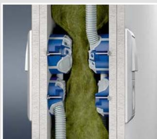
Für Schallschutzwände mit einem Schalldämmwert bis 69 dB.
