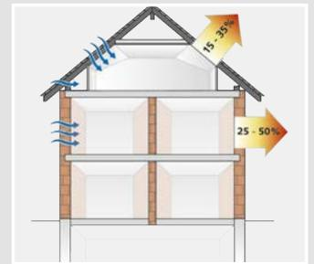
Insbesondere bei der Hohlwand-Bauweise ist die luftdichte Gebäudehülle, die wesentlich durch die in der Wand gespannte Dampfsperffolie gewährleistet wird, eine wichtige Voraussetzung für das Erreichen der vorgeschriebenen Energiewerte. Jede konventionelle Installationsöffnung durchtrennt diese luftdichte Hülle und sorgt für unkontrollierte Leckluftströme, die oft die Wirkung sonstiger Energiesparmaßnahmen massiv schwächen.
