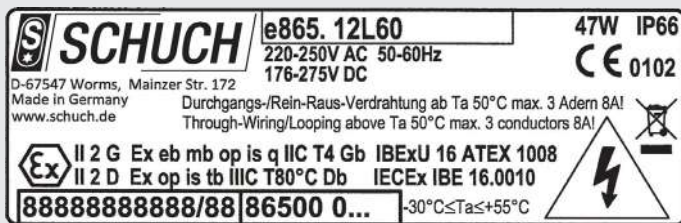
Bild 9: Beispiel für Kennzeichnung einer explosionsgeschützten Leuchte
