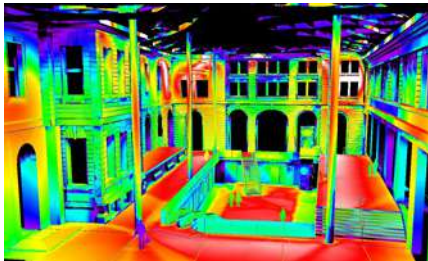
Ci-dessus, simulation d'un éclairage fonctionnel à différentes intensités et ci-dessous simulation de l'éclairage poussé à son maximum pour la mise en valeur des façades.
