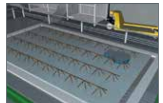
Betonfertigteil wird gegossen.
