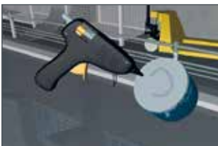
XL 170 Großdose mit Heißkleber auf den Schaltisch kleben.
