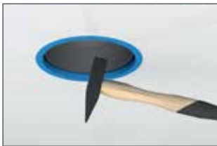
Lüftungshülse von unten mit Hammer einschlagen.
