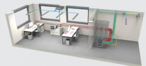
Seit Kurzem kann die strukturierte LAN-Verkabelung erste Gebäudefunktionen (blau), z.B. einzelne Sensoren oder LED-Lichtquellen, integrieren. Um die LAN-Verkabelung dafür entsprechend zu erweitern, bietet sich Digital Ceiling an.
