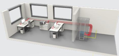
Die strukturierte LAN-Verkabelung (rot) mit Ethernet/IP-Datenübertragung wird seit Jahrzehnten für die Erschliessung von Arbeitsplätzen genutzt.
