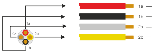
Bild 2: Sternvierer - Kennzeichnung mit Farben
