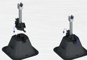
**Isolierte Leitungsstütze**, zur Erhöhung der Fangleitung auf Flachdächern mit Betonsockel eckig 16 kg, Edelstahlkeil, Unterlegplatte und Niro-Clip für ø 8 mm \*) **Typ A (fL)**.
