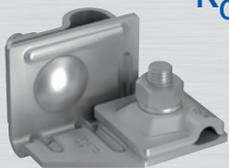
Verbindungsklemme zur Reduzierung des  $k_c$ -Wertes auf Faktor 0,25 durch Aufteilung des Strompfades über die Fangstange auf 4 Ableitungen
