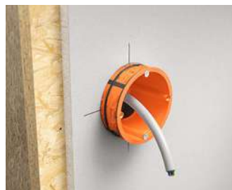
Mittenkennzeichnungen an der ersten Klemmrippenreihe und Zentrierstege für die exakte Positionierung und Einführung der Dose, ohne Verkanten in der Installationsöffnung.
