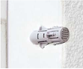
Durch das Eindrücken des Befestigungskerns werden die Schwenkschneiden in dem Dämmmaterial verankert und geben dem Mini-Geräteträger sicheren Halt.
