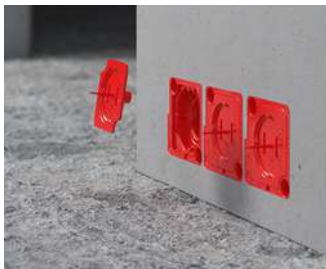
Wiederverschließbarer Verschlussdeckel - Schutz vor Beton während des Transports und beim Aufstellen des Wandelements auf der Baustelle.
