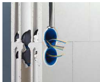
In die Schallschutzdose können Leitungen bis Ø 11,5 mm und Rohre bis M25 eingeführt werden.
