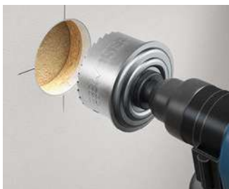
Exakte Einbauöffnung Ø 68 mm mit KAISER-Fräser (z. B. MULTI 2000 HM, Art.-Nr. 1083-70) mit Randversenk erstellen.
