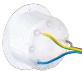
Werkzeugloses Durchstoßen der Anschlussadern bis 2,5 mm 2 durch vorgestanzte Einführungsmarkierungen.
