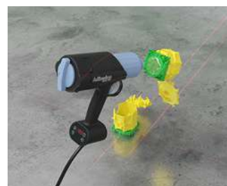
Befestigung mittels Heißkleber.
