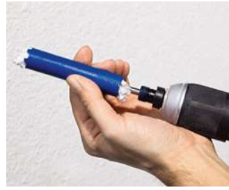
Fräskrone lösen und Bohrkern entfernen.
