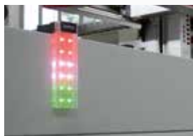
Stufenweise Ausleuchtung des Leuchtkörpers
