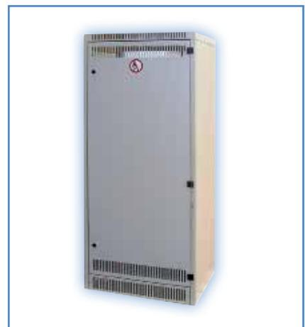
Alle Gehäuse werden pulverbeschichtet und einbrennlackiert produziert. Alle Gehäuse entsprechen der Schutzart IP 20. Die Türen sind rechts angeschlagen. Türen der Standgehäuse sind in einem Winkel von 180° zu öffnen. Zur Anpassung an andere Gehäuse können zusätzlich Gehäusesockel von 100 bzw. 200 mm Höhe geliefert werden.
