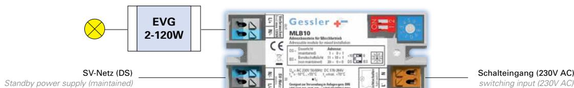
Unter Einsatz des Gessler MLB10-Bausteins können die drei Schaltungsarten (Dauer-, Bereitschafts- und geschaltetes Dauerlicht) in einem Stromkreis realisiert werden. Das bedeutet eine erhebliche Einsparung bei der Installation bzw. Reduzierung der Brandlast. Der Baustein kann in AC- und DC Netzen verwendet werden.
