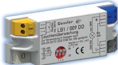
Die Adressbausteine LB1/009 und LB1/009DD können sowohl in AC- als auch in DC-Systemen eingesetzt werden. Bei beiden Spannungsformen wird keine separate BUS-Leitung benötigt. Die Kommunikation erfolgt auf der Netzzuleitung.
