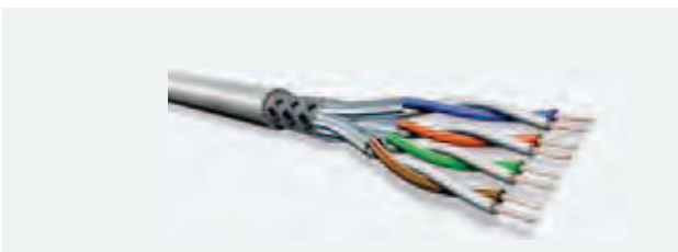
S/FTP: engl. braid screened shielded twisted pair; Gesamtschirm aus Geflecht, Aderpaare einzeln mit Folienschirm versehen. Häufigste Bauform geschirmter Leitungen, in der Praxis auch als PiMF (Paare in Metall-Folie) bezeichnet
