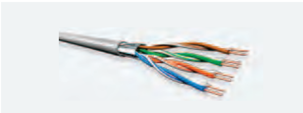
F/UTP: engl. foil screened unshielded twisted pair; Gesamtschirm aus metallisierter Folie, kein Paarschirm; in der Praxis auch als FTP-Kabel bezeichnet
