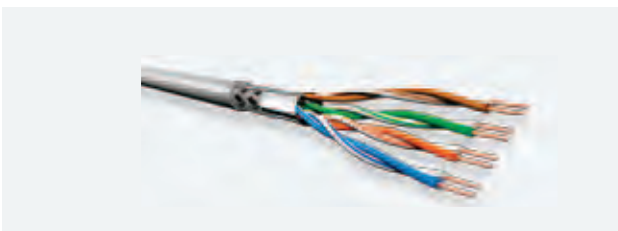
SF/UTP: engl. braid and foil screened unshielded twisted pair; Gesamtschirm aus metallisierter Folie und Geflecht, kein Paarschirm
