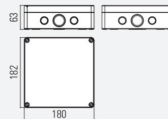
Abgesetzte Versorgungseinheit für Akku-Leuchte zur Montage im temperierten Innenbereich. Kabellänge max. 4 m (2,5 mm<sup>2</sup>) bauseits.
