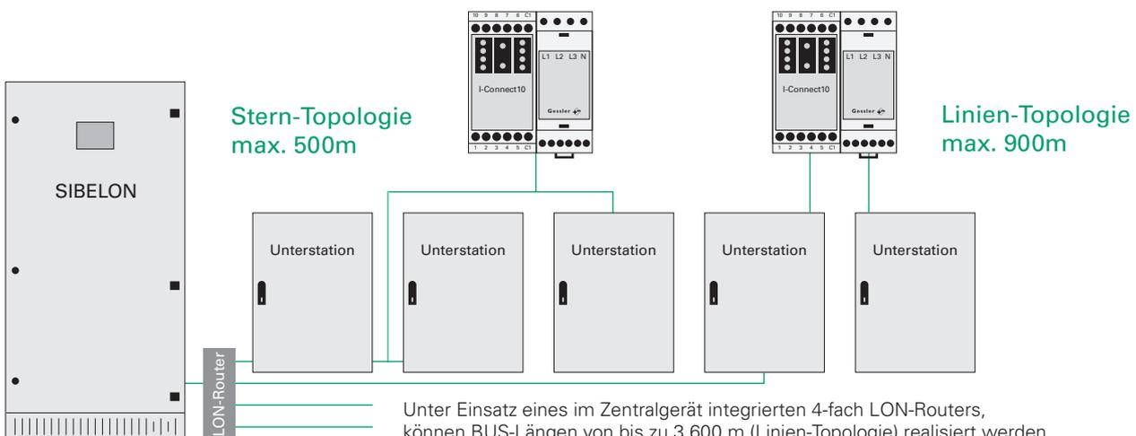
Unter Einsatz eines im Zentralgerät integrierten 4-fach LON-Routers, können BUS-Längen von bis zu 3.600 m (Linien-Topologie) realisiert werden. Es können max. 2 Stk. 4-fach LON-Router integriert werden.
