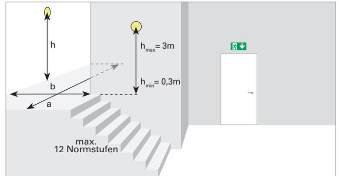
**AUSLEUCHTUNG von FLÄCHEN > 60m<sup>2</sup> (Antipanikbeleuchtung) – EN 1838**
