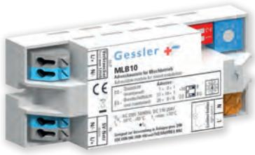
Unter Einsatz des Gessler MLB10-Bausteins können Rettungs- und Sicherheitsleuchten in einem Stromkreis (Mischtechnik) realisiert werden. Das bedeutet eine erhebliche Einsparung bei der Installation bzw. Reduzierung der Brandlast. Der Baustein ist sowohl für AC- als auch für DC-Netze geeignet.
