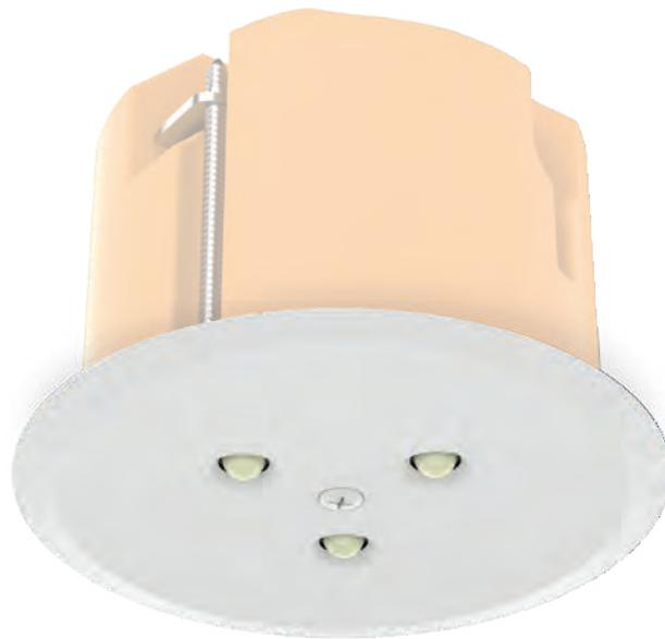
LED-Sicherheitsleuchte in rundem Design mit symmetrischer Ausleuchtung für den deckenbündigen Einbau in eine bestehende Geräte-Verbindungs-dose mit Norm-Kombinationsabstand von 71 mm gemäß DIN 49073-1 (tiefe Ausführung). Geeignet zur Ausleuchtung von Flächen- und Rettungswegen gemäß DIN EN 1838.
