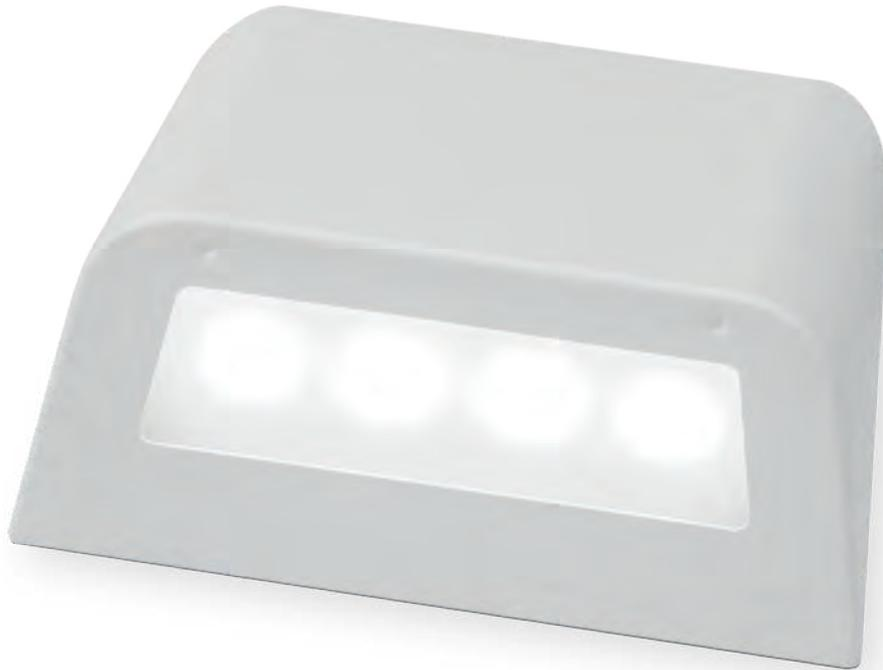
Optisch identisch, unterscheiden sich die beiden Leuchten bei den „inneren Werten“. Während der PM5 für den Außenbereich entwickelt wurde (IP65), haben wir den LM5 mit einer geringeren Schutzart (IP41) konstruiert. Um einer direkten Blendung entgegen zu wirken, besitzt der LED-Master LM5/PM5 eine satinierte Scheibe, welche einen Abstrahlwinkel von 45° aufweist. Konzipiert zur Ausleuchtung von Flächen im Innen- und Außenbereich gemäß DIN EN 1838.
