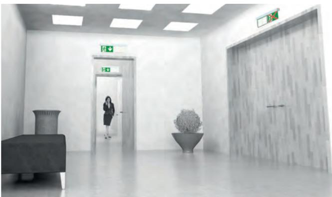
Während des Normalbetriebs kennzeichnet die Pfadfinder-Leuchte den 1. Fluchtweg. Die Kennzeichnung des alternativen 2. Fluchtweges ist blind.
