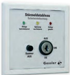
Das Meldetableau MT2 ist sowohl als Aufbau- (MT2-A) als auch als Einbauversion (MT2-E) erhältlich. Letzteres ist zum Einbau in eine bestehende Geräte-Verbindungsdose mit Norm-Kombinationsabstand von 71mm gem. DIN 49073-1 geeignet.
