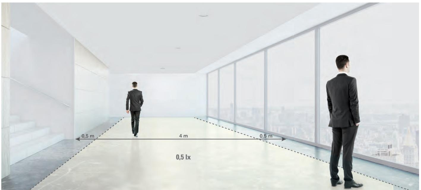
Gemäß DIN EN 1838 können breitere Rettungswege als mehrere 2 m breite Streifen betrachtet werden oder mit einer flächigen Antipanikbeleuchtung ausgerüstet werden. Wir empfehlen die Ausrüstung mit einer flächigen Antipanikbeleuchtung (0,5 Lux).
