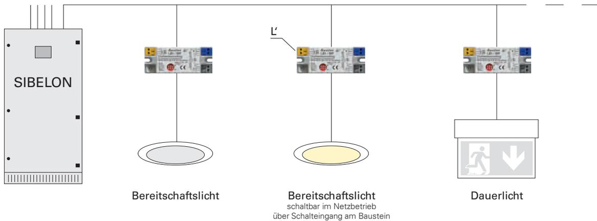
Unter Einsatz des Gessler LB1/009DD-Bausteins können Rettungs- und Sicherheitsleuchten in einem Stromkreis (Mischtechnik) realisiert werden. Das bedeutet eine erhebliche Einsparung bei der Installation bzw. Reduzierung der Brandlast. Der Baustein ist sowohl für AC- als auch für DC-Netze geeignet.
