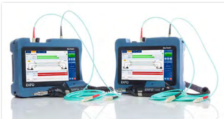
Dämpfungsmessung, ORL Link-Zertifizierung, SM / MM, bidirektional und onboard Berichterstellung mit dem EXFO MaxTester-945
