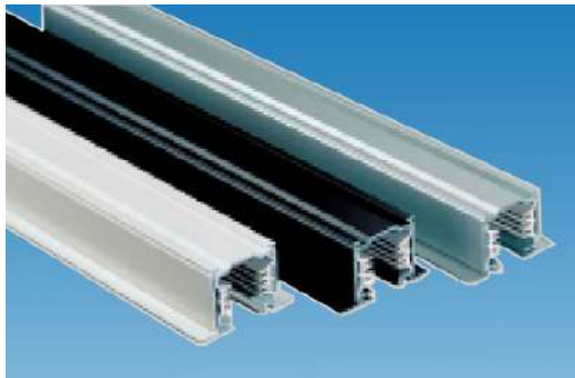
3-Phasen-Flügel-Einbaustromschiene (440V 16A CL1), Einbauöffnung 37mm
