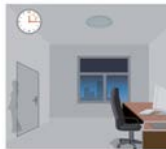
Le capteur éteint la lumière automatiquement après un certain temps s'il n'y a pas de mouvement détecté
