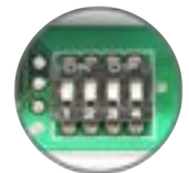
DIP Switch Réglage courants
