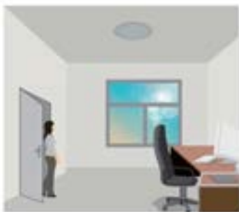
Avec suffisamment de lumière naturelle, le DP ne s'allume pas alors que la présence est détectée
