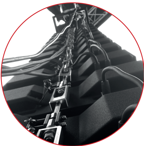
Verstellung der Spindelmechanik auch unter Last möglich
