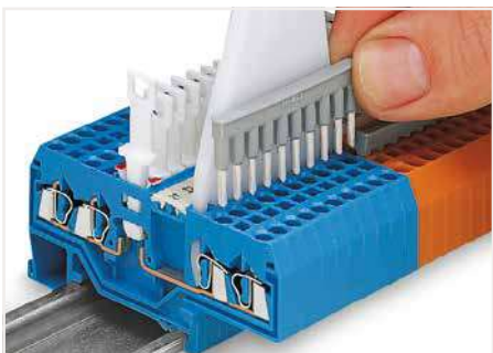
Brücken von Trennklammern mit Frontverdrahtung mit Brückungskämmen unter Zuhilfenahme eines 10-fach-Betätigungswerkzeuges
