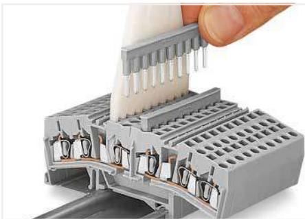
Verwendung als Potentialvervielfacher Einsetzen eines 10-fach-Brückungskamms (nur im inneren Bereich möglich!)
