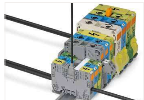
Potentialabgriff (283-407) in der Reihenklemme immer bis zum Anschlag hinunterdrücken!
