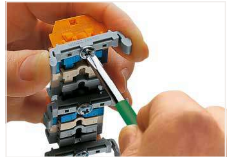
Klemmenleiste; mit Befestigungsflanschen, Anschrauben des Montagefußes (209-123) (Der Abstand der Montagefüße zueinander unter einer Klemmenleiste soll ca. 20 ... 25 mm betragen.)
