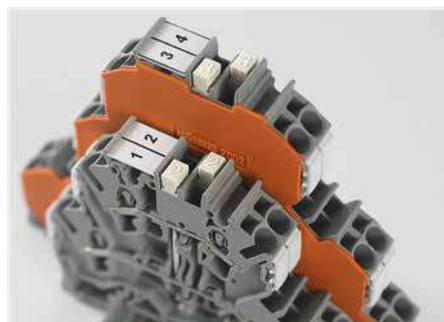
Die Vertikalbrücker für das Reihenklennenprogramm TOPJOB® S verbinden in Doppel- und Dreistockklennen zwei beziehungsweise drei Ebenen miteinander. Ob es sich um einen Doppelstock-Vertikalbrücker (2002-492) oder einen Dreistock-Vertikalbrücker (2002-493) handelt, signalisieren die auch im gesteckten Zustand gut sichtbaren Ziffern „2“ und „3“.
