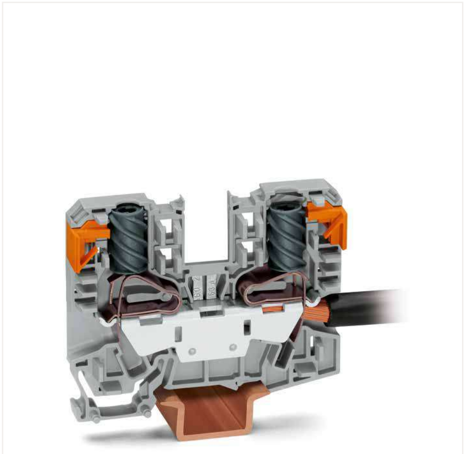
Leiteranschluss – Schritt 3 Durch kurzen Linksdreh Dreh Sperre entriegeln ①. Nach Rückführen des Betätigungswerkzeuges ② ist der Leiter sicher geklemmt.
