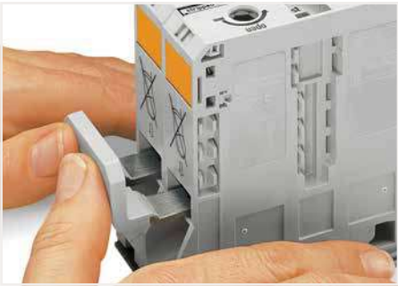
Brücken benachbarter Klemmen mit Querbrückern oberhalb der Leitereinführung, vor Leiteranschluss; der Nennquerschnitt bleibt erhalten.
