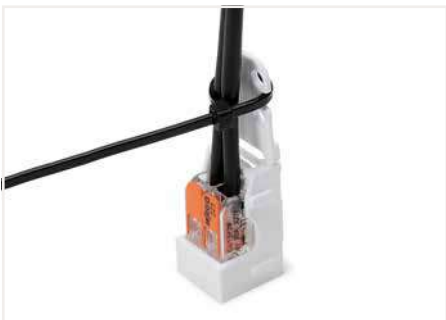
Zugentlastung mit Kabelbinder herstellen.
