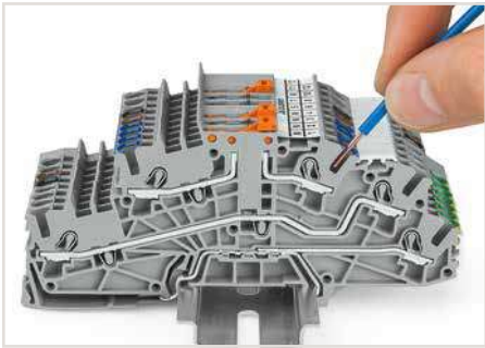
Leiter anschließen – direkt stecken. Eindrätige Leiter lassen sich bis zu einem Querschnitt über und mindestens zwei Querschnittsstufen unter dem Nennquerschnitt direkt stecken, ohne Werkzeug.
