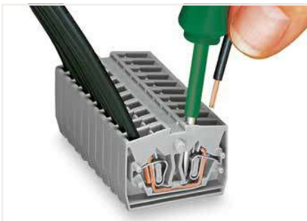
CAGE CLAMP®-Anschluss Leiter anschließen. Bei Verwendung der Nennquerschnitte mit Aderendhülsen ist jeweils der nächst kleinere Leiterquerschnitt zu wählen.
