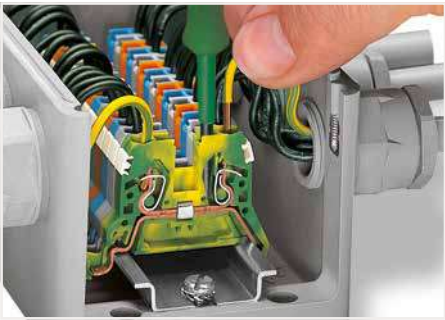
CAGE CLAMP®-Anschluss Leiter anschließen (0,08 ... 4 mm² „f“). Bei Verwendung der Nennquerschnitte mit Aderendhülsen ist jeweils der nächst kleinere Leiterquerschnitt zu wählen.
