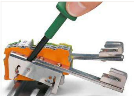
Sammelschienenhalter mittels Betätigungswerkzeug Typ 3, Klinge (5,5 x 0,8) mm demontieren.
