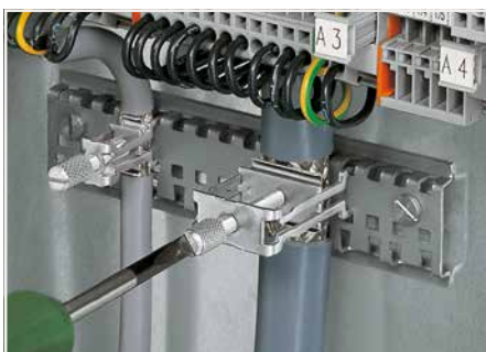
Nach dem Aufstecken die Rändelschraube festdrehen. Empfohlenes Anzugsmoment der Schraube 0,5 Nm
