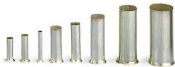
Aderendhülse; ohne Kunststoffkragen; galvanisch verzinkt; Elektrolytkupfer; gasdicht aufgedrimpt; gemäß DIN 46228, Teil 4/09.90
