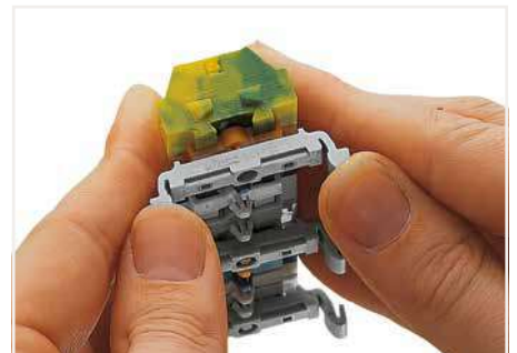
Klemmenleiste; mit Rastfüßen; Anrasten des Montagefußes (209-123) (Der Abstand der Montagefüße zueinander unter einer Klemmenleiste soll ca. 20 ... 25 mm betragen.)
