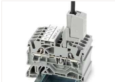
Der Prüfabgriff (2009-182) passt für die Serien 2000 bis 2016, für den werkzeuglosen Anschluss individueller Prüflleitungen bis 2,5 mm 2 .
