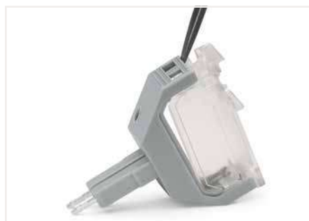
Öffnen des Deckels mittels Betätigungswerkzeug (Klinge 2,5 mm)
