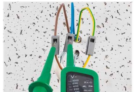
Prüfen in separater Prüföffnung
