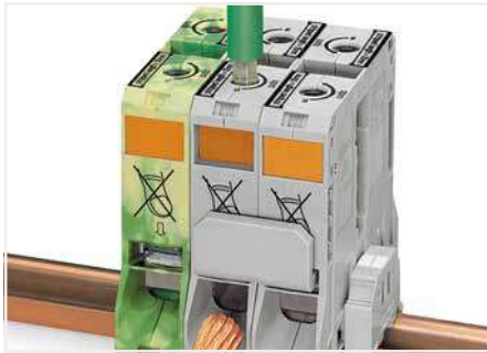
Leiteranschluss – Schritt 2 Abisolierten Leiter bis zum Anschlag in die Klemmstelle führen und in dieser Position halten.
