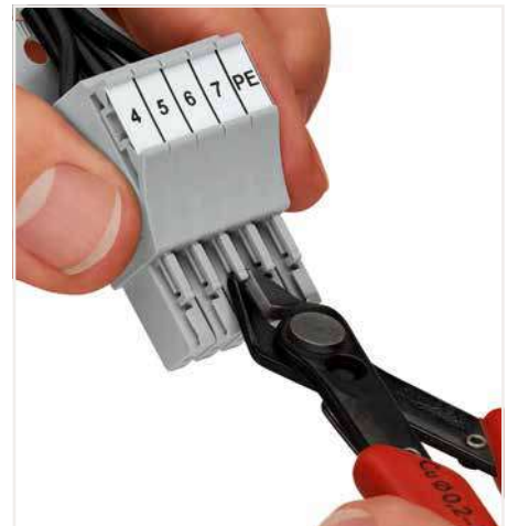
Federleiste kodieren, gewünschte Kodiernase mittels geeignetem Werkzeug von der Federleiste abtrennen.
