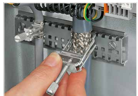
Zum Demontieren eines Schirmklemmbügels die Rändelschraube über den Druckpunkt hinaus aufdrehen und Klemmbügel unter leichtem Abkippen entnehmen.
