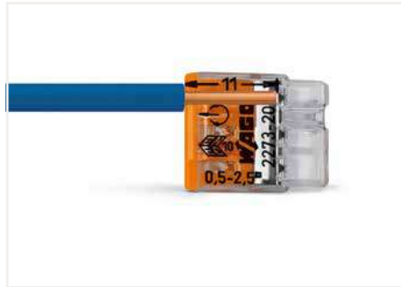
Eindräftigen Leiter gemäß dem aufgedruckten Maß 11 mm abisolieren.
