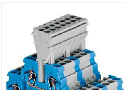
Bei Steckabgriffleisten ab 7-polig sind drei Module mit Verdrehenschutz zu verwenden.
