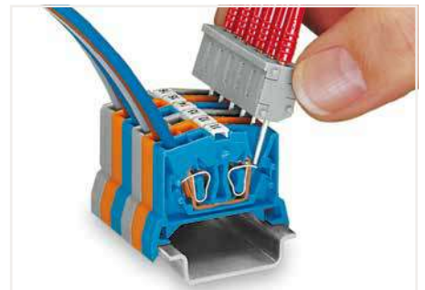
Tippkontaktierung, über die Feder des CAGE CLAMP®-Anschlusses, begrenzt den Nennstrom auf maximal 0,5 A und die maximale Prüfspannung auf 48 V; die Prüfstifte sind nicht berührungsgeschützt.
