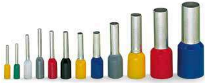
Aderendhülse; mit Kunststoffkragen; galvanisch verzinkt; Elektrolytkupfer; gasdicht aufgedrimpt; gemäß DIN 46228, Teil 4/09.90
