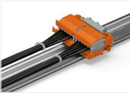
Liegende Montage auf Tragschiene 35 mittels Universal-Winkeladapter
