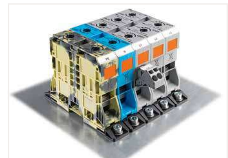
Die Befestigung auf der Montageplatte erfolgt jeweils mit zwei M8-Zylinderkopfschrauben und entsprechenden Unterlegscheiben.
