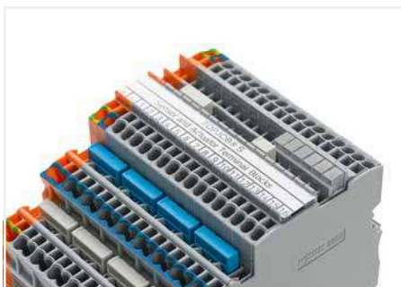
Brücken: Signalebene Brücken der Signalebene mit Kammbrückern (Serie 2000); Ausführungen mit einer LED nur in einer Brückerspur brückbar! Prüfadapter sind in allen Brückerspuren verwendbar!
