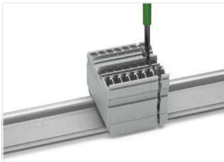
Verband mit Betätigungswerkzeug (Klinge 3,5 x 0,5 mm) öffnen.
