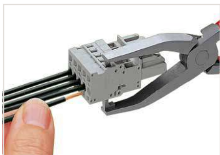
Betätigungswerkzeug Leiter anschließen – seitliche Verdrahtung am Beispiel einer Federleiste Bei Verwendung der Nennquerschnitte mit Aderendhülsen ist jeweils der nächst kleinere Leiterquerschnitt zu wählen.
