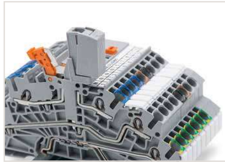
Bei Installationsetagenklennen mit interner N-Trennung können bei getrenntem N-Potential Prüfadapter in den freigewordenen Vertikalprüfschacht eingesetzt werden.
