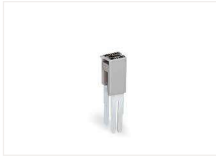
Reduzierbrücker von 10/6 mm 2 auf 6/4 mm 2 I N 30 A, Bestellnr. 284-413
