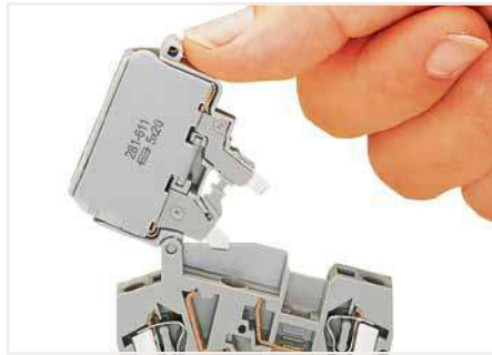
Sicherungswechsel Vor dem Auswechseln der Sicherung, Sicherungshalter in Endposition ausschwenken (Raststellung).
