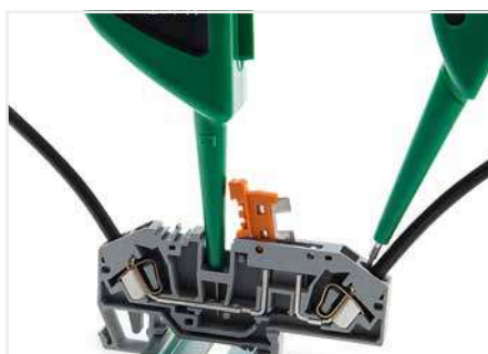
Prüfen, hier im Brückerschlitz
