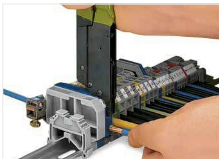
Zum Auslösen der Rastsperrre die Griffe über den Rastpunkt hinweg zusammendrücken. Betätigungszange von der Klemme nehmen und auf die nächste Klemme umsetzen. Feststehenden Zapfen der Betätigungszange in die obere Löseöffnung der Reihenklemme stecken, danach die bewegliche Klaue in die seitliche Löseöffnung einhängen. Griffe bis zum Rastpunkt zusammendrücken – die Klemmstelle wird ganz geöffnet. Beide Hände sind frei für die Vorbereitung und Einführung des Leiters in die Klemme.
