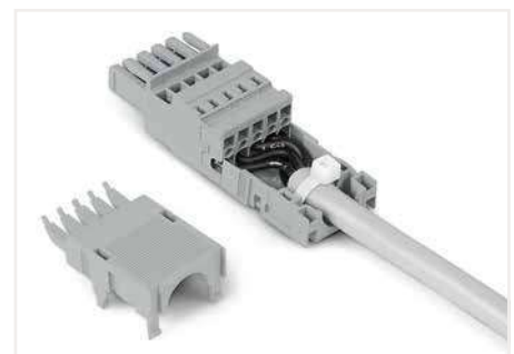
2- bis 5-polige Zugentlastungsgehäuse besitzen 1 Kabelausgang hinten. 6- bis 9-polige Zugentlastungsgehäuse besitzen 2 Kabelausgänge und 1 Verschlusskappe. 10- bis 16-polige Zugentlastungsgehäuse besitzen 3 Kabelausgänge und 2 Verschlusskappen.
