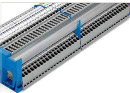
Der schmale Sammelschienenträger (1,5 mm dick) dient als zusätzliche Stütze der Sammelschiene bei langen Klemmenreihen (alle 200 mm).
