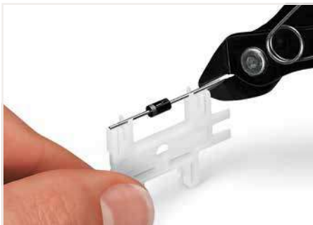
Bauelement auf richtige Länge bringen.
