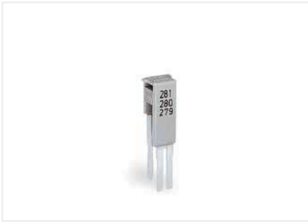
Reduzierbrücker von 10/6 mm 2 auf 4/2,5/1,5 mm 2 I N 15 A, Bestellnr. 284-414
