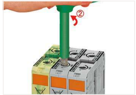
Leiteranschluss – Schritt 3 Durch weiteren kurzen Linksdreh ② wird die Sperre aufgehoben und der Innensechskantschlüssel ohne Kraft zurückgeführt. Der Leiter ist sicher geklemmt.
