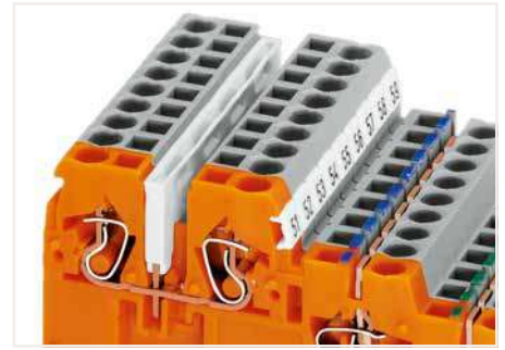
Brücken der Signalebene durch Einsatz der isolierten Kammbrücker – Serie 870 Je nach Anwendung 2- bis 9-fach LED-Ausführung nicht brückbar!
