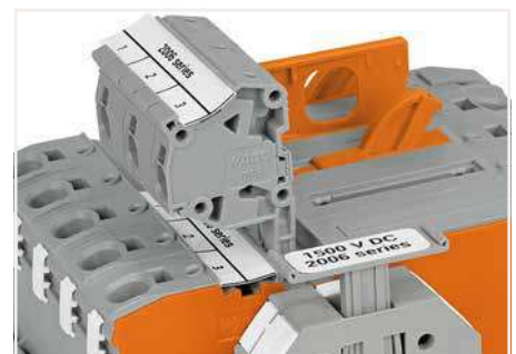
Alternativ kann auch mit Steckverbindern (2006-511) von Klemme 1 auf 2 gemessen werden. Aufgrund der Klem- menbreite von 15 mm sind zusätzlich Blindmodule (2006-549) zu verwenden.
