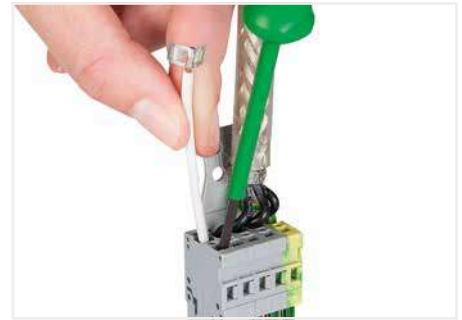
Schirmübergabe mittels Betätigungswerkzeug in die Federleiste einsetzen.
