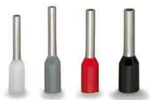
Aderendhülse; mit Kunststoffkragen; galvanisch verzinkt; Elektrolytkupfer; gasdicht aufgecrimpt; gemäß DIN 46228, Teil 4/09.90
