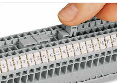
Brücken mit Querbrückern (280-402) Querbrücker bis zum Anschlag hinunterdrücken!
