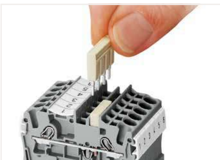
Kammbrücker einsetzen und bis zum Anschlag hinterdrücken.
