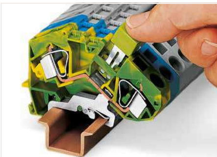
Schutzleiterklemmen lassen sich mit Querbrückern in einer Richtung (über die Klemmenrückwand) mit Durchgangsklemmen brücken. Zusätzlich zur Kennzeichnung dieser Klemmen empfehlen wir die Verwendung der gelbgrünen Querbrücker.
