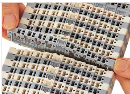
Klemme kräftig nach außen drücken und von der Tragschiene hebeln.
