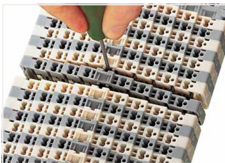
Verband mit Betätigungswerkzeug, Klinge (2,5 x 0,4) mm, öffnen.
