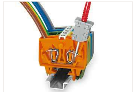
Prüfen über CAGE CLAMP®-Anschluss an der Stromschiene – möglicher Nennstrom 6 A; durch CAGE CLAMP®-Betätigung können einzelne Prüfkontakte geklemmt werden. Die maximale Prüfspannung beträgt 400 V.
