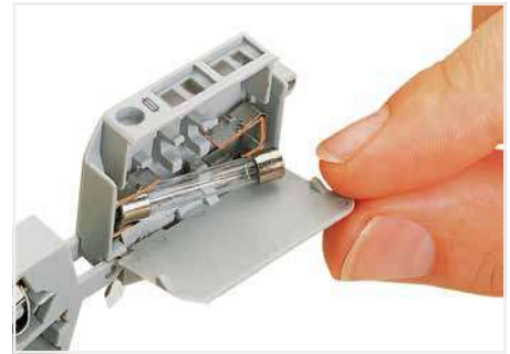
Sicherungswechsel Die Sicherung wird beim Ausklappen des Verschlussdeckels automatisch aus dem Sicherungshalter herausgeholt.
