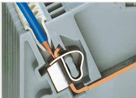
Isolierungsstopp Kein Eindringen der Leiterisolation in die Klemmstelle! Lieferbar für Klemmen bis 4 mm 2
