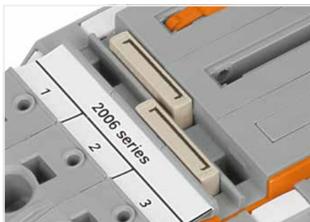
Mit den Kammbürckern von 1 auf 3 (2006-433) und von 1 auf 5 (2006-435) kann die Klemme (Klemmenbreite 15 mm) gebrückt werden.
