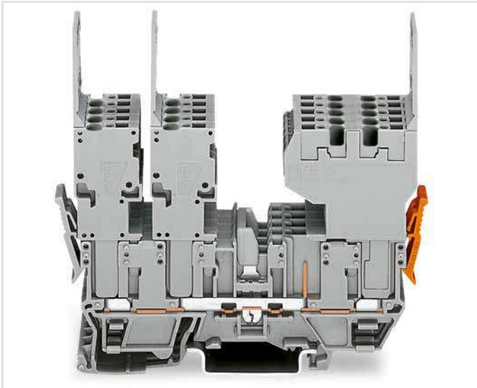
2 x 1-Leiter-Federleisten links, 1 x 2-Leiter-Federleiste rechts, auch umgekehrt möglich – Basisklemmen sind mit Brückersystemen der Serien 280 und 780 brückbar, prüfbar mit Prüfadapter 280-4...
