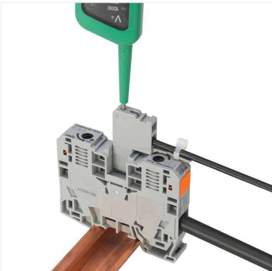
Durch die seitliche Verdrahtung lassen sich auch eingeschränkt biegsame Leiter großen Querschnitts gut anschließen.
