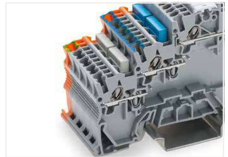
Brücken von PE Bei Initiatoren-/Aktorenklemmen ohne PE-Kontaktierung zur Tragschiene kann die PE-Verbindung über die Brückung zur Klemme mit PE-Fuß erfolgen.
