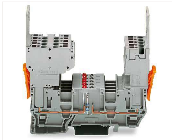
2-Leiter-Federleiste und 1-Leiter-Federleiste auch umgekehrt möglich LED-Basisklammern sind mit Brückersystemen der Serien 280 und 780 brückbar, prüfbar mit Prüfadapter 280-4...
