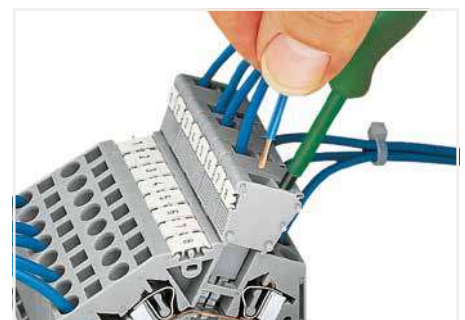
CAGE CLAMP®-Anschluss 0,08 ... 1,5 mm 2 ; Modulbreite 5 mm 0,08 ... 2,5 mm 2 ; Modulbreite 6 mm
