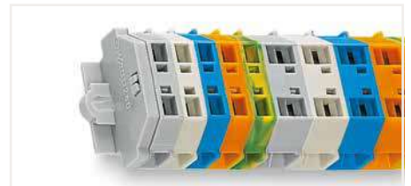
Klemmenleiste; mit Befestigungsflanschen; für Schraub- u. ä. Befestigungsarten; Befestigungslöcher Ø 3,2 mm (mit Montagefuß (209-123) auch für Tragschiene 35)
