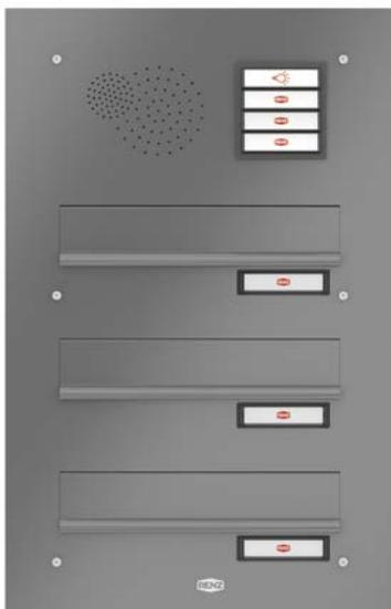
Elegante flache Frontplatte mit nur 2 bzw. 2,5 mm Dicke. Verschraubung der Front mit den Kästen mittels Kunststoff-ecken, auch ohne Frontüberstand verbaubar. Auf Wunsch mit RS1001-Abschlussrahmen und integriertem Regenabweiser lieferbar. Erhältlich aus Galfan-Stahl, Aluminium oder Edelstahl V4A. Alternativ aufklappbar lieferbar.
