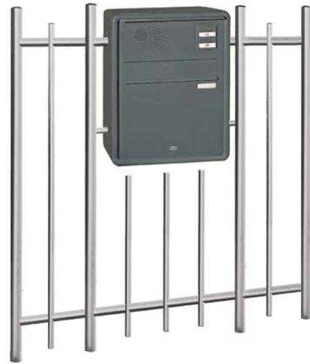
Modernes, eckiges Design bietet die hochwertig verarbeitete Verkleidung QUADRA. Mit dem integrierten Regenabweiser ausgestattet ist sie ideal geeignet für den Außenbereich. Der Einwurf der Post erfolgt von vorne, die Entnahme von hinten. Gefertigt wird die Verkleidung aus umlaufendem Aluminium-Profil, pulverbeschichtet oder eloxiert lieferbar.
