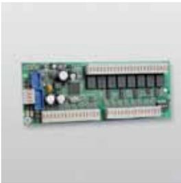
**i** Der Einbau des Erweiterungsmoduls ist erst ab Gehäusotyp GR80 möglich!
